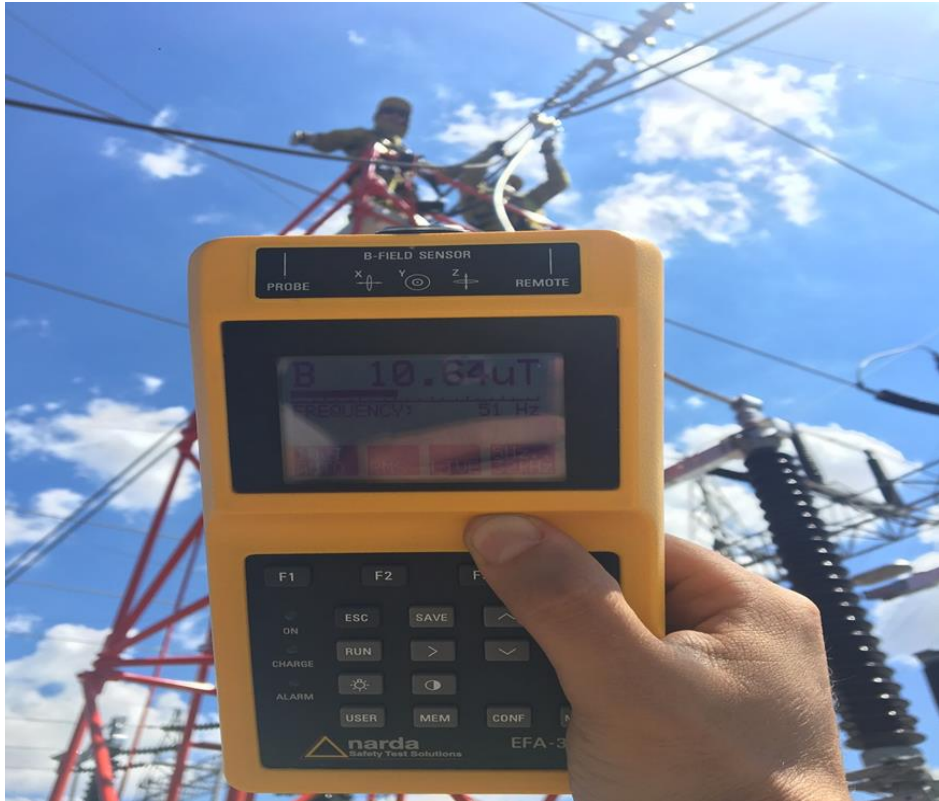
Şekil 4.15: Canlı bakım sırasında anlık manyetik alan ölçümü
