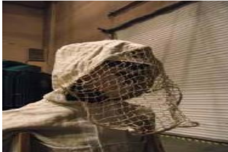
Şekil 2.10: BUTE Yüksek Gerilim Laboratuvarı'nda geliştirilen iletken ek yüz örgüsü(Göçsei, Gábor, Bálint Németh, and Dániel Tarcsa 2013).
