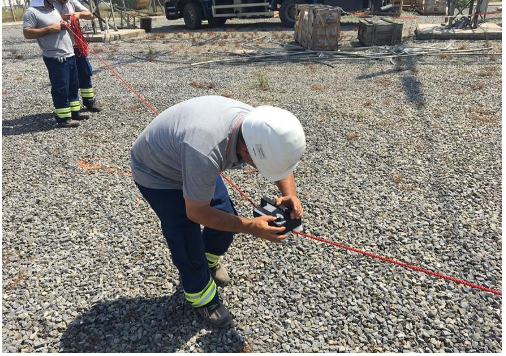
Şekil 3.16: CB çalışmasında kullanılacak izole halatın testinin yapılması
