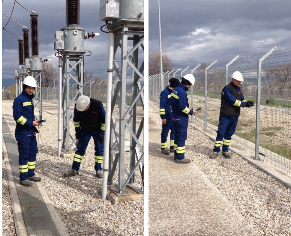
Şekil 7.9: Adım ve dokunma gerilimi saha ölçümleri
