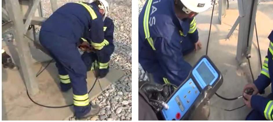
Şekil 7.7: Dal akımları ölçümü saha çalışması
