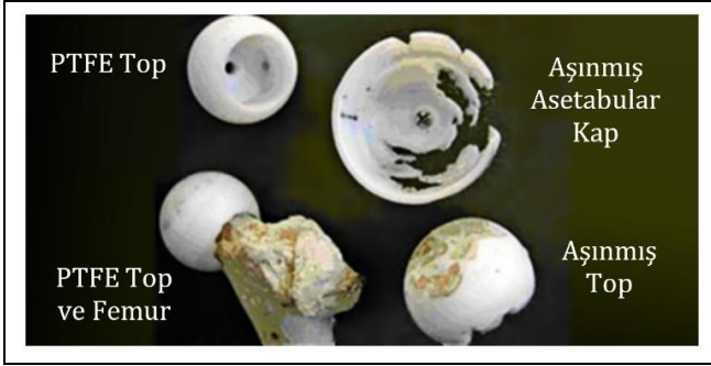
Şekil 7: Total kalça protezinde aşınma [46].
