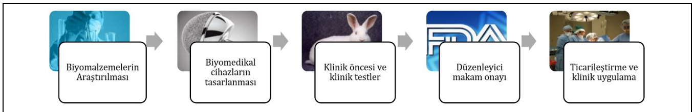
Şekil 1: İmplantların tasarım aşamaları [2].
