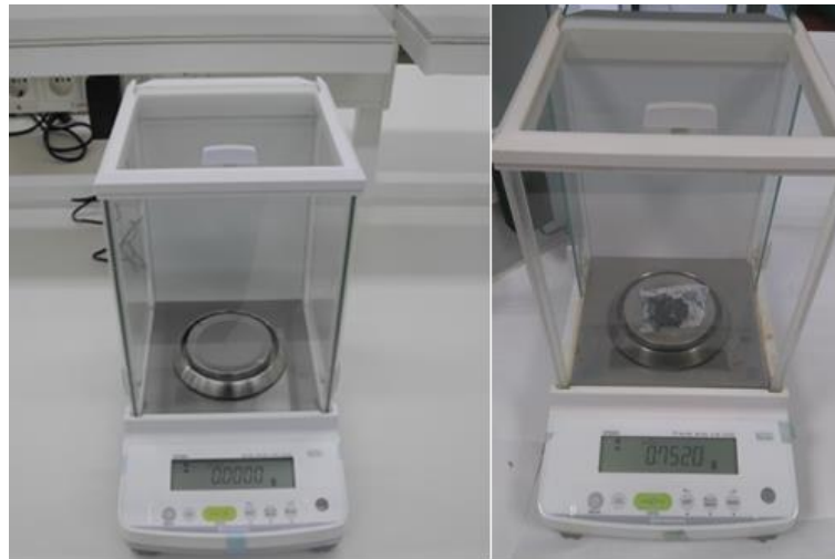
Şekil 6.5: 1 \times 10^{-4} g Hassasiyette Ölçüm Terazisi
