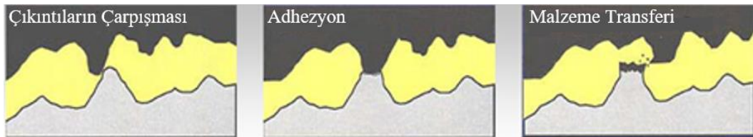
Şekil 2.16: Adhezyon Aşınması Çalışma Mekanizması (Olomolehin 2009)
