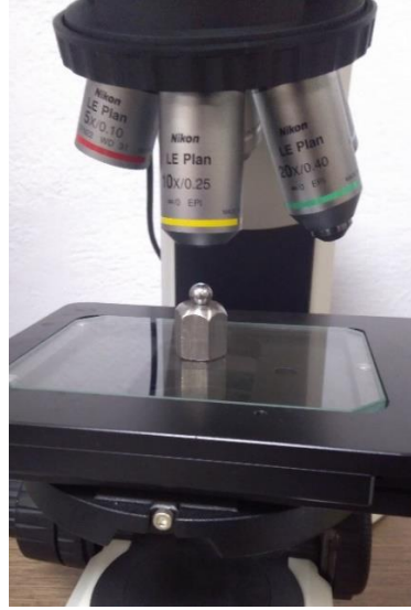
Şekil 6.27: Bilye Tutucu Aparat ve Bilye
