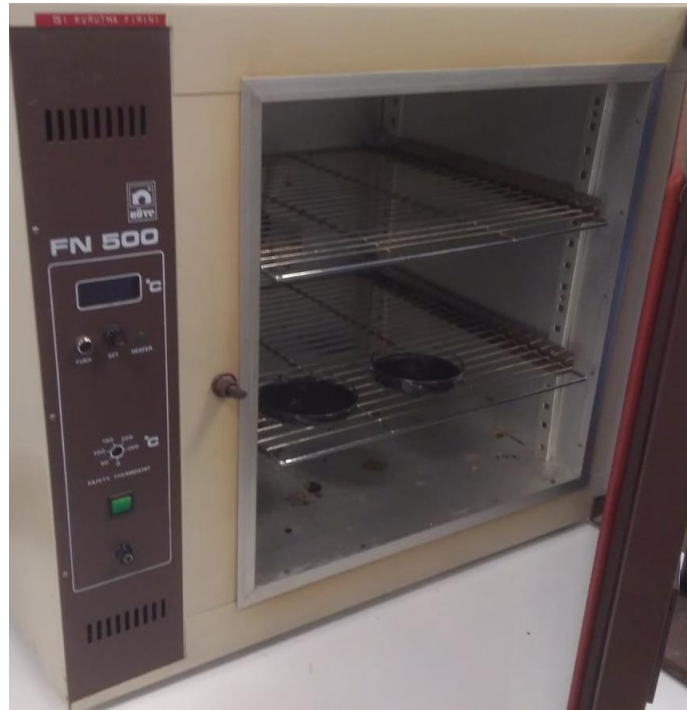
Şekil 6.2: Grafen Oksitin Fırında Kurutulması
