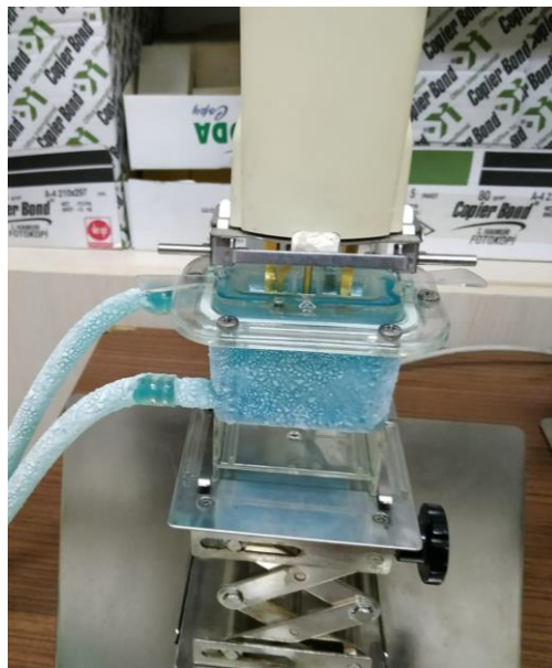
Şekil 6.13: Soğutucu Akışkanın -17 °C Olduğu Durum
