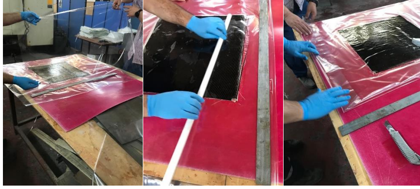
Şekil 3.6: Release filmin kaplanması ve rulo yardımıyla içindeki havanın alınması işlemi
