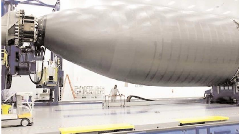
Şekil 2.6: Boeing 787 Dreamliner'ın burun ve kokpit bölümünün üretimi (Frohs ve Jaeger 2011).
