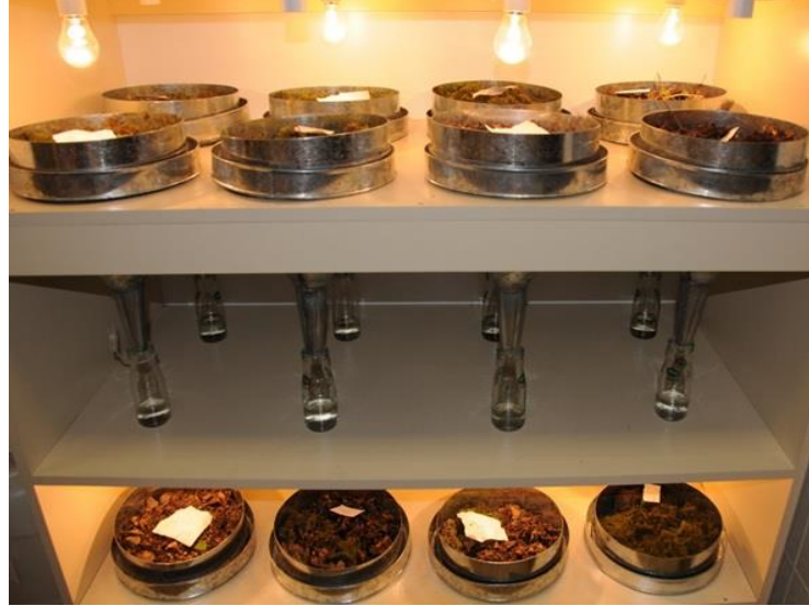
Şekil 3. 3: Berlese düzeneğine yerleştirilen örnekler.
