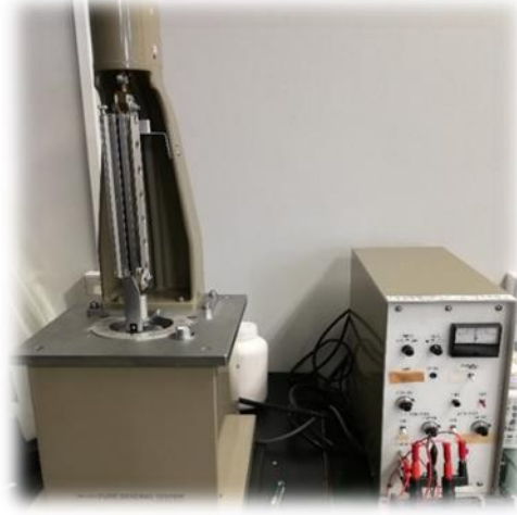
Şekil 2.2: KES-FB2 S Bending Tester (Eğilme testi)
