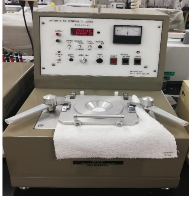
Şekil 2.9: KES-F8-AP1 Air Permeability Tester (Hava geçirgenliđi test cihazı)
