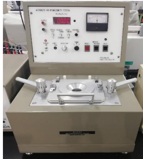
Şekil 4.8: KES-F8 AP1 Hava geçirgenliği ölçüm ünitesi
