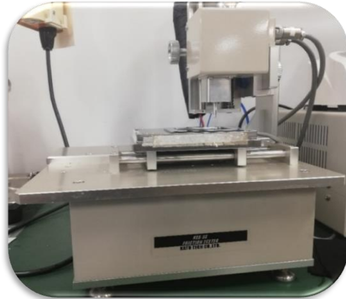
Şekil 2.7: KES-SE-STP Surface Tester (Yüzey Testi)
