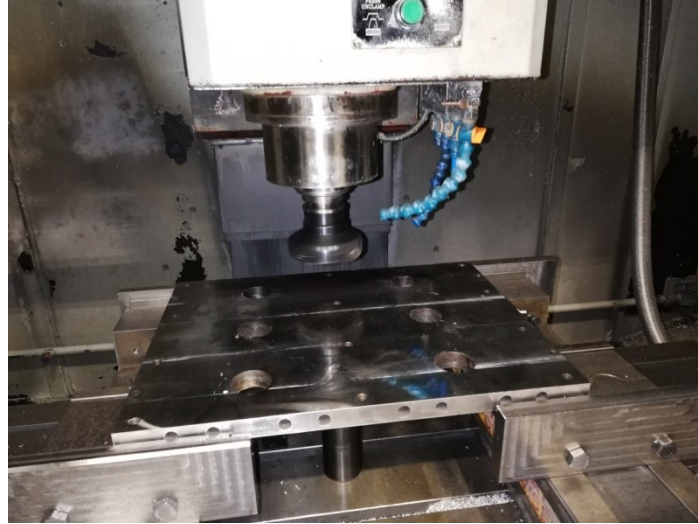
Şekil 3.5 Kalıp Isıtma Tablasının CNC Tezgahta İşlem Görme Anı
