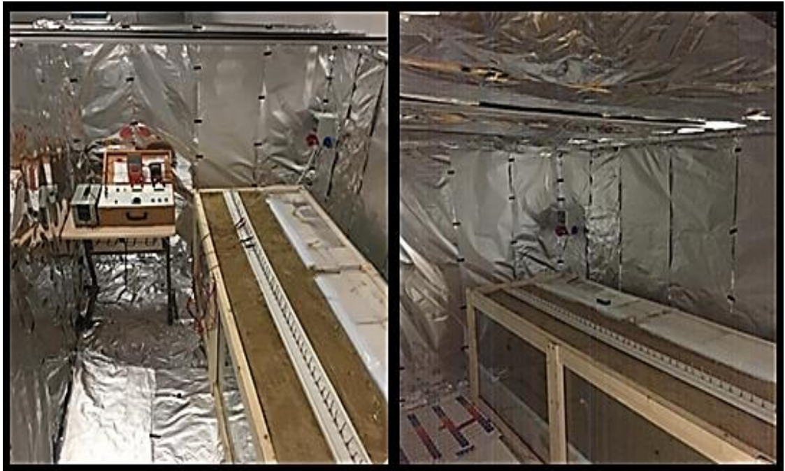
Şekil 5.2: Modelleme çalışmalarının sonuçları, dış manyetik alanlardan korunması için hazırlanmış olan faraday kafesinin görüntüsü.
