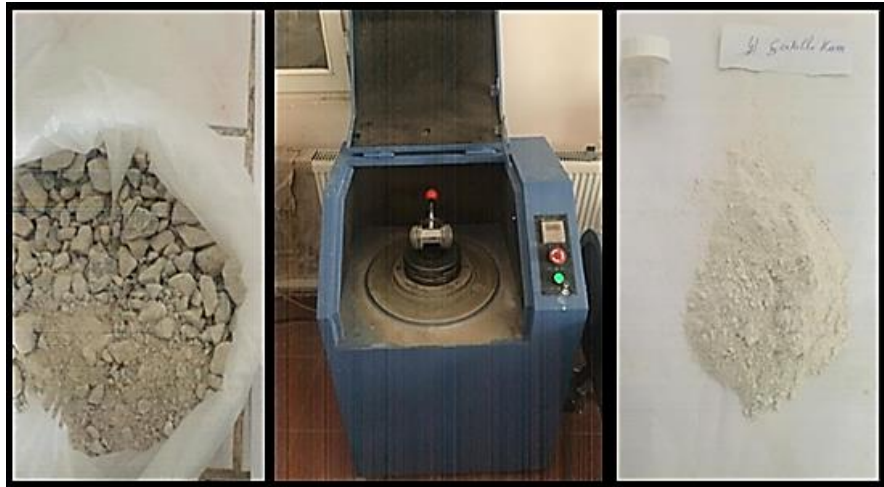
Şekil 5.6: XRF analizi için numune hazırlanması
