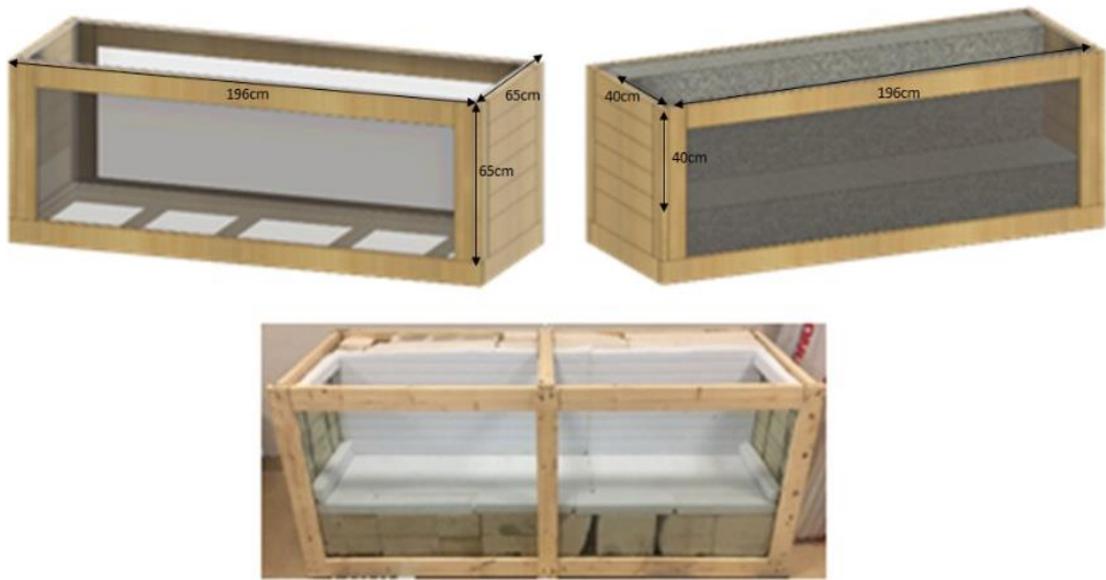
Şekil 5.1: Laboratuvar ortamında modelleme çalışmaları için kullanılmış olan deney tankının hazırlanması
