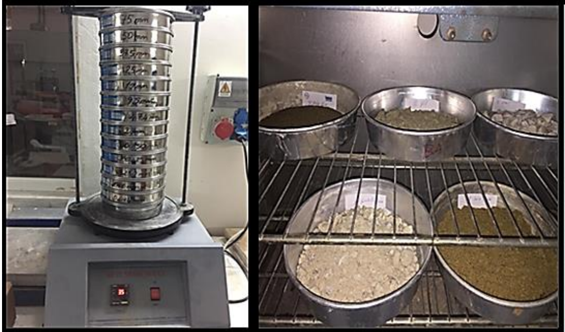
Şekil 5.3: Modelleme çalışmalarında kullanılan numunelerin sınıflandırılması için yapılan ele analizi aşamaları.
