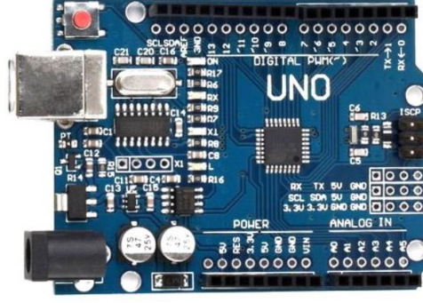
Şekil 4.3: Arduino Uno R3 kartı (Web Anonim 5 2020).
