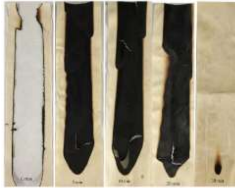
Şekil 1.25: Farklı daldırma sürelerinde işlem gören kumaş örneklerinin dikey yakma testi sonrası görüntüleri (Liu ve diğ. 2016).
