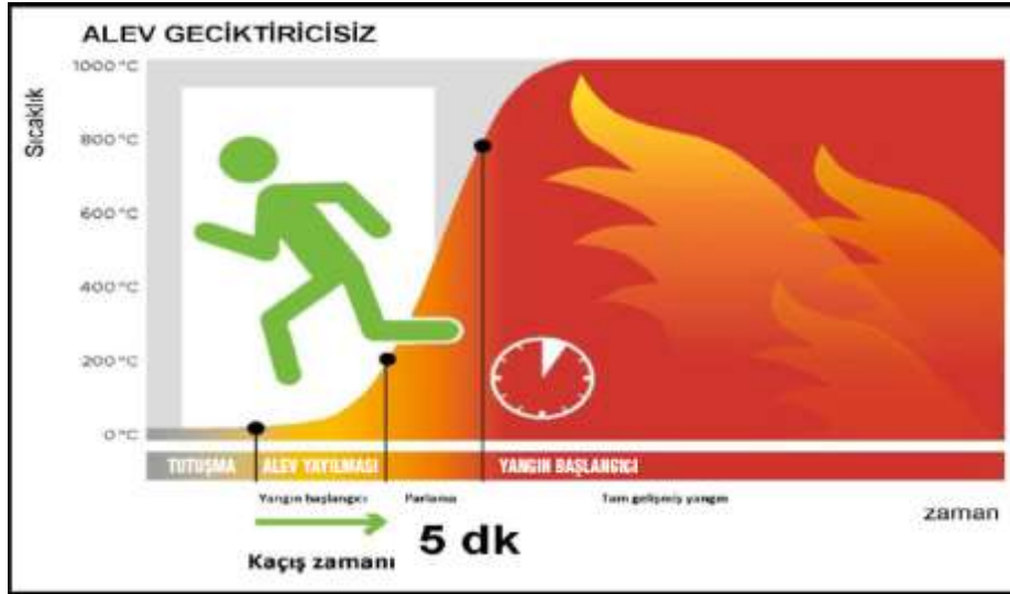
Şekil 1.1: Güç tutuşurluk malzemesi kullanılmayan bir ortamda yangın anı başlangıcı (Yücel ve Gül 2017).
