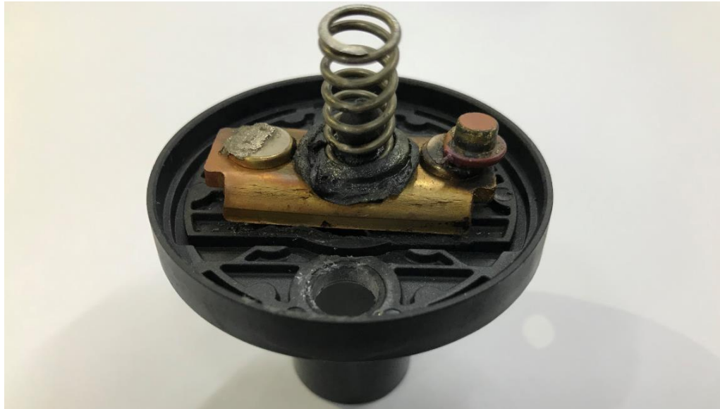
Şekil 7.2: Test sonrası AgCdO perçinlerinin kaynaması
