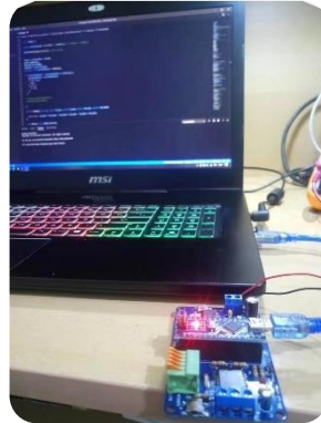
Şekil 5.10: PlatformIo IDE geliştirme ortamı üzerinde yazılımın derlenmesi
