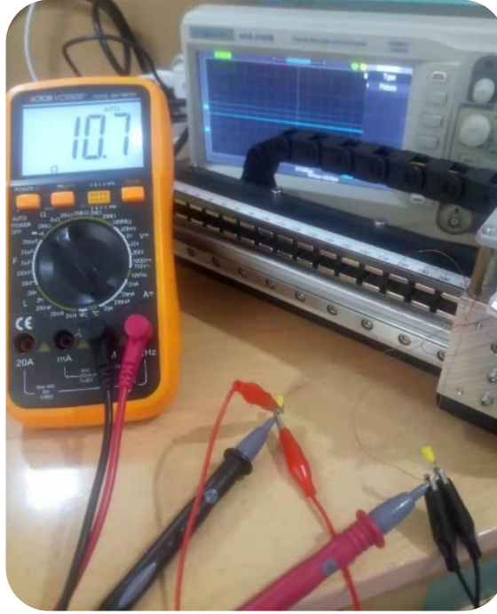
Şekil 6.10: C fazı bobin direnç ve endüktans değerlerinin ölçümü
