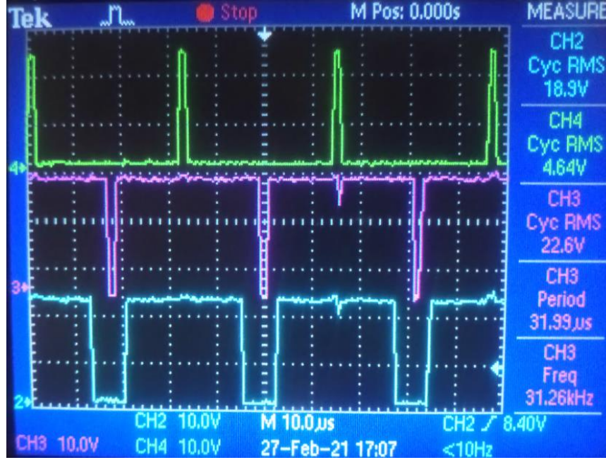
Şekil 6.16: Boşta çalışma durumunda A, B ve C fazlarına uygulanan PWM dalga formu
