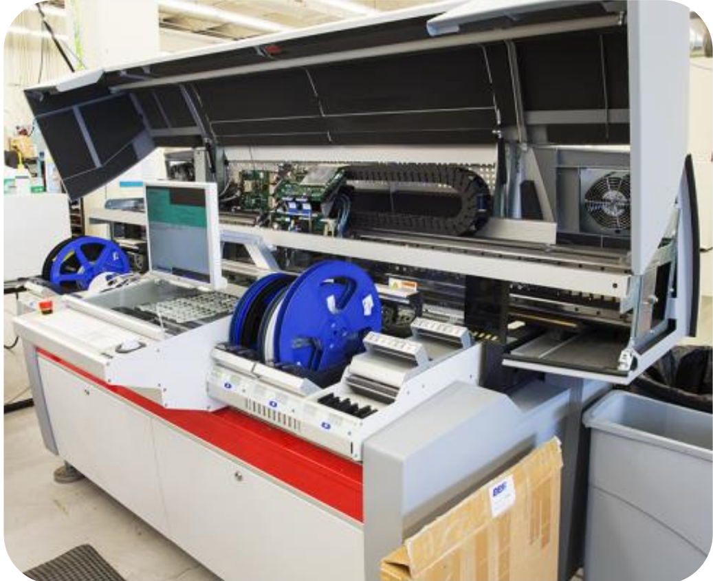
Şekil 2.8: Fırçasız lineer motorlarla donatılmış yüksek hızlı pick and place makineleri
