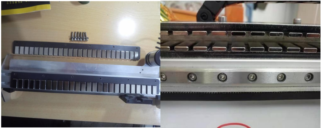
Şekil 6.1: Mıknatısları yerleştirilmiş stator gövde
