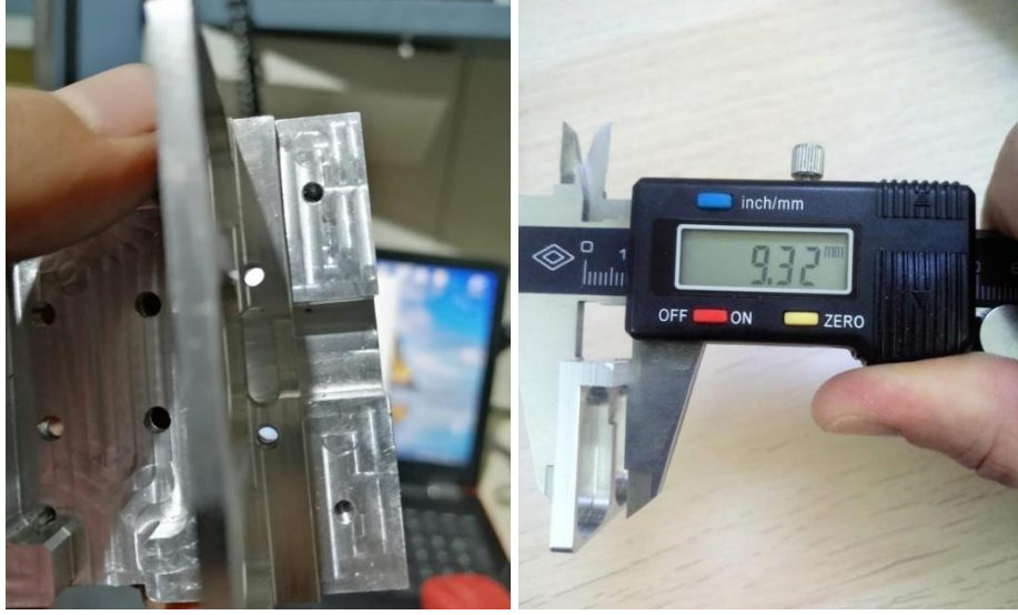
Şekil 6.2: Cnc tezgahından çıkan forcerın boyut kontrolü
