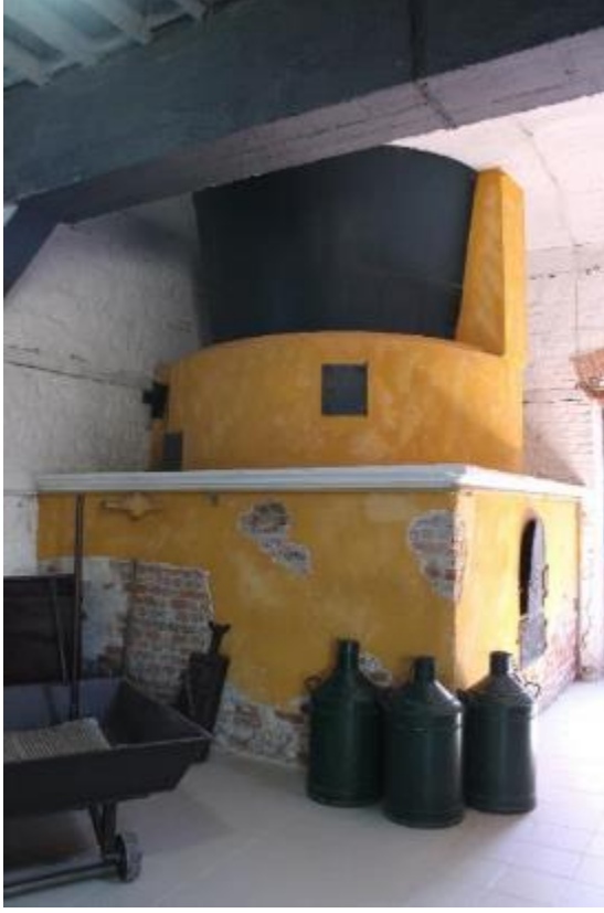
Fotoğraf 269: Ayvacık Küçükkuyu Burnaz Sabunhanesi Zemin Kattaki Sabun Kazanı Ocağı (M. Çiftyürek)
