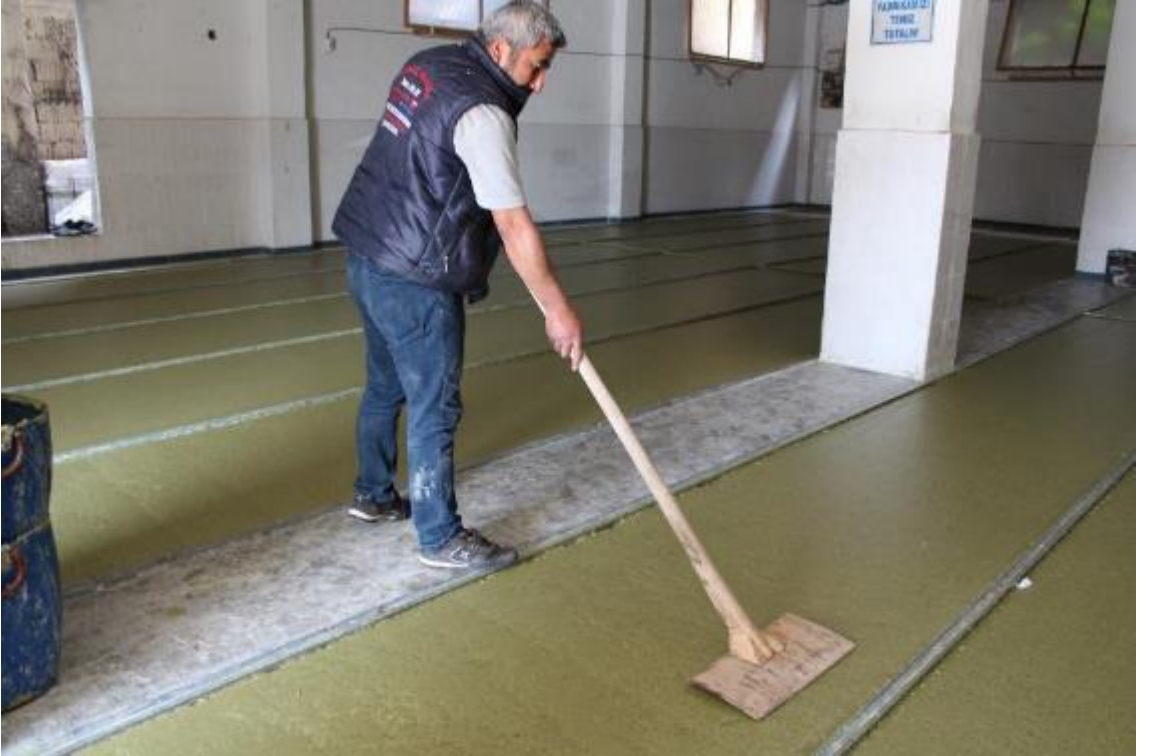
Fotoğraf 36: Patpat Denilen Aletle Sabun Yüzeyinin Düzeltilmesi (Nizip Doktoroğlu Yağ ve Sabun Sanayi Tic. Ltd. Şti.)
