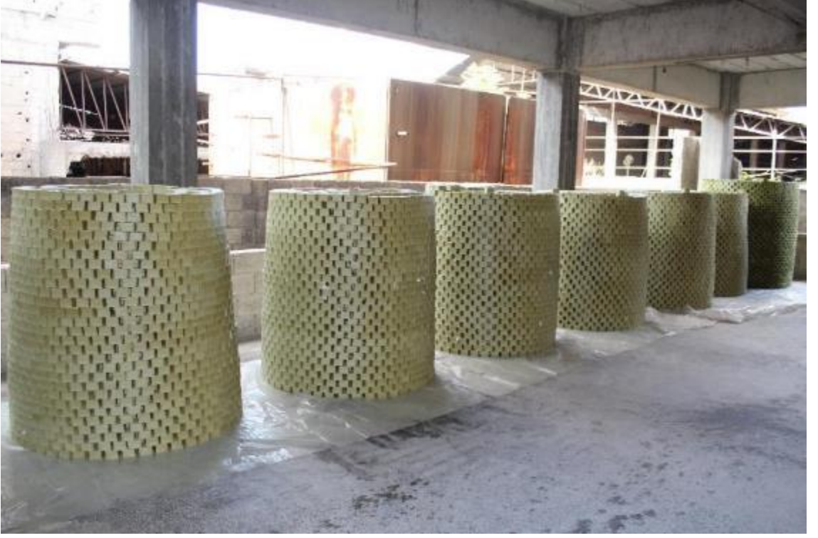
Fotoğraf 49: Sabun Kalıplarının Kurutulması (Nizip Doktorođlu Yađ ve Sabun Sanayi Tic. Ltd. Őti.)
