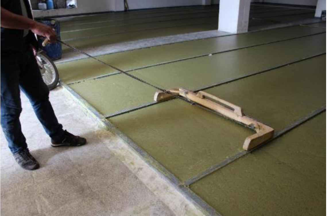
Fotoğraf 34: Sürgü veya Sıyrığ ile Sabun Hamurunun Düzeltilmesi İşlemi (Nizip Doktoroğlu Yağ ve Sabun Sanayi Tic. Ltd. Şti.)
