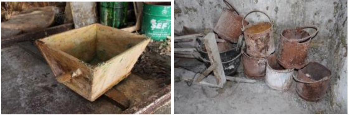
Fotoğraf 28: Sabun Hamurunu Taşımak İçin Ahşap ve Metal Kovalar (Ayvalık Karşınlar ve Antakya Hasan Ökten Sabunhanesi)
