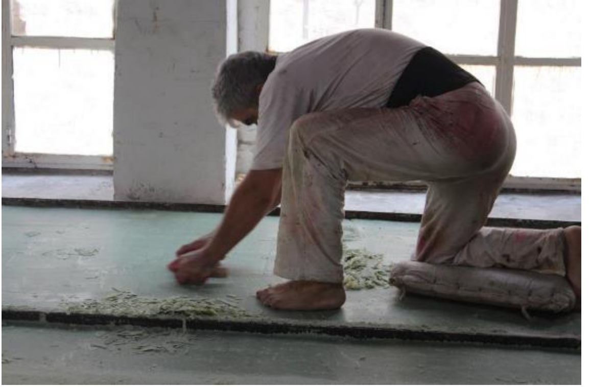
Fotoğraf 39: Raspa veya Perdah İle Sabun Yüzeyinin Traşlanması (Ayvalık Karşınlar Sabunhanesi)
