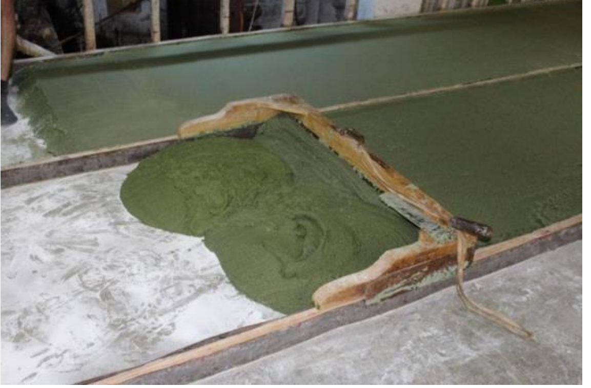
Fotoğraf 35: Sürgü veya Sıyrığ ile Sabun Hamurunun Düzeltilmesi İşlemi (Ayvalık Karşınlar Sabunhanesi)
