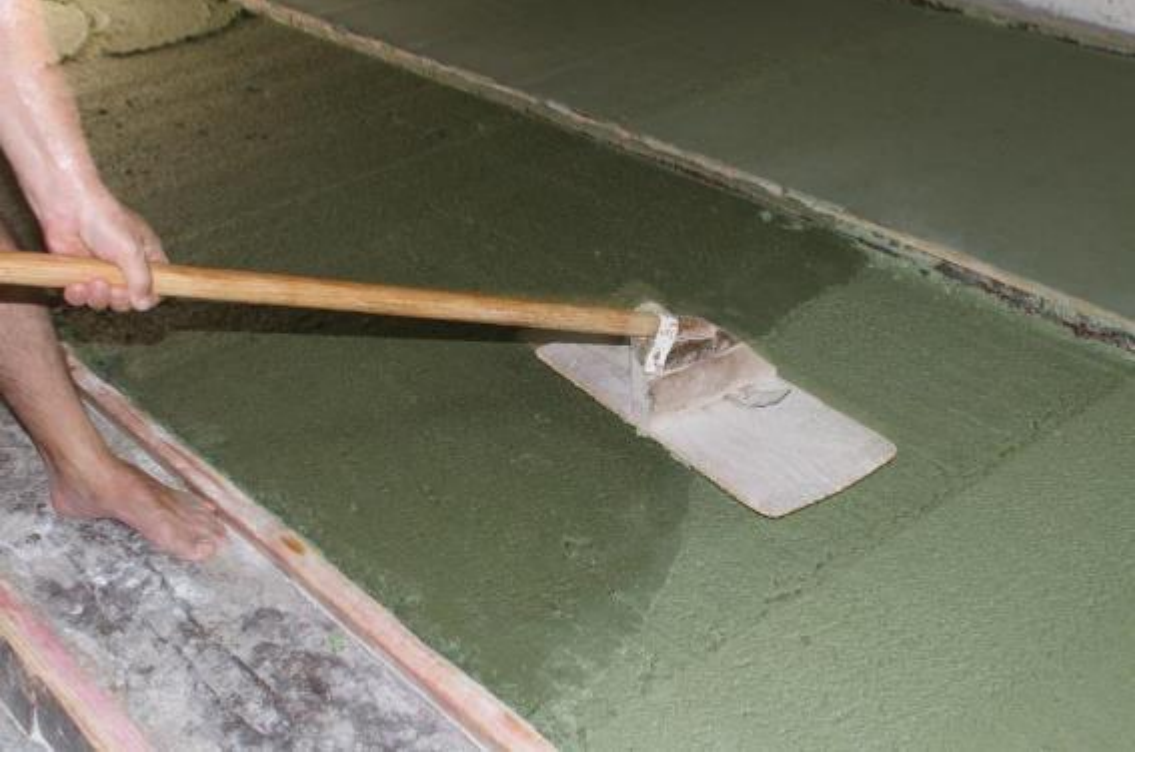
Fotoğraf 37: Patpat Denilen Aletle Sabun Yüzeyinin Düzeltilmesi (Ayvalık Karşınlar Sabunhanesi)
