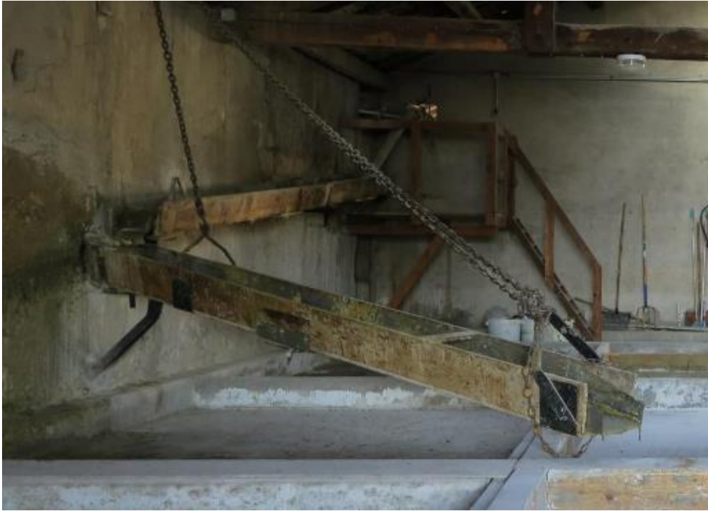
Fotoğraf 64: Sabunu Kazanın Ağız Kısımına Yerleştirilen Ahşap Kanal (M. Amador-M. Bouchenino-L. Hausrat, age, s. 66; https://www.marius-fabre.com/fr/ Erişim Tarihi:27.04.2020)
