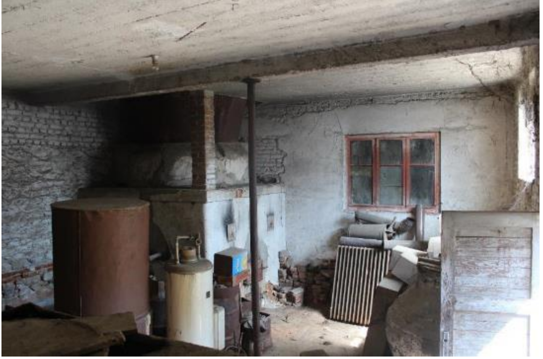
Fotoğraf 209: Edremit Ali Rıza Karagözoğlu Sabunhanesi Zemin Kattaki Sabun Kazanı Ocağı (M. Çiftyürek)
