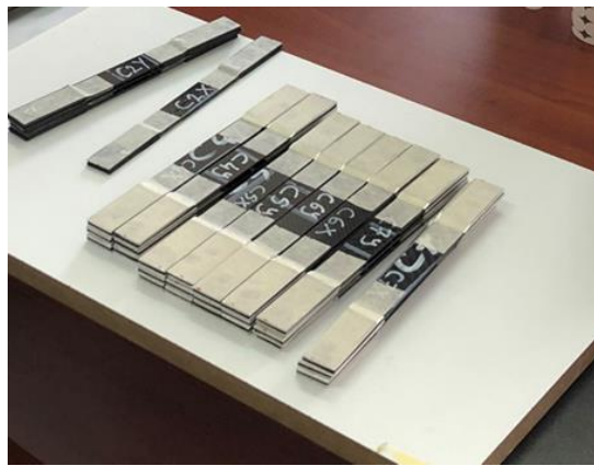
Şekil 3.5: Alüminyum parça yapıştırma işlemi sırasında çekme testi numuneleri
