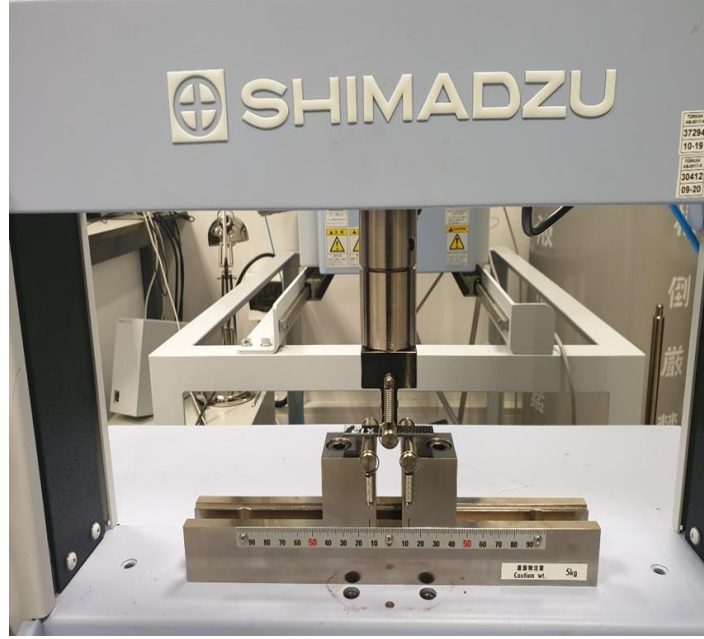
Şekil 3.6: Üç noktalı eğilme testlerinin gerçekleştirildiği SHIMADZU test cihazı
