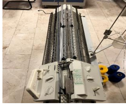
Şekil 3.1: Kumaşların üretildiği Passap Duomatic 80 örme makinesi
