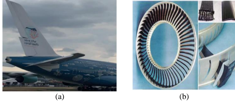
Şekil 1.2: (a) Empenajı ve üst gövde paneli GLARE'den imal edilmiş A380 yolcu uçağı (Irving ve Soutis 2019) (b) Aramid/karbon sa örgü jet motoru statör vanası (Kumar ve Thakur 2017)
