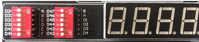
Şekil 5.19: Eğitim seti üzerindeki 7 segment display modülü.
