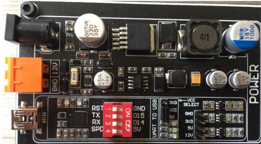
Şekil 5.7: Arduino-Arm Uyumlu Esnek Yapılı Mikrodenetleyici Eğitim Seti besleme katı.
