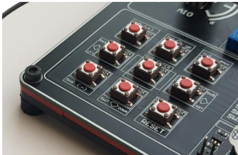
Şekil 5.10: Arduino-Arm Uyumlu Esnek Yapılı Mikrodenetleyici Eğitim Seti buton takımı.
