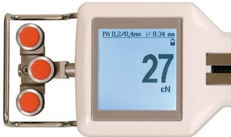
Şekil 3.25:Tension View DTMX-500 iplik tansiyon cihazındaki ölçümü sağlayan silindirler
