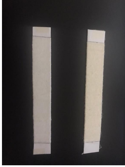
Şekil 3.27: İplik-iplik sürtünme katsayısının 90 derece açı ile hesaplanmasında kullanılan ham ve kasarlı kartonlar
