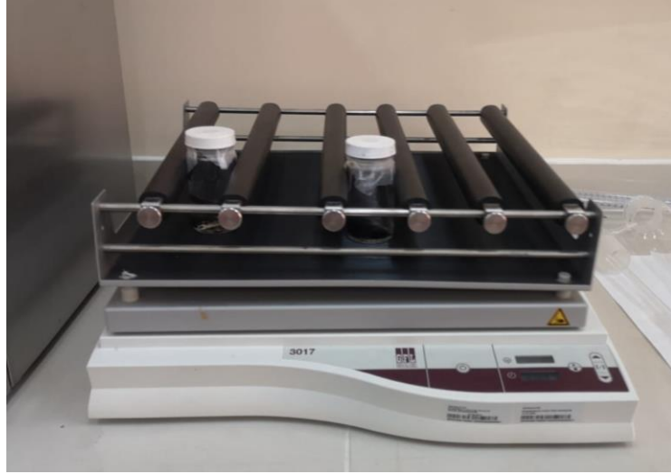
Şekil 4.8: Adsorbanlardan siloksanların ekstraksiyonu
