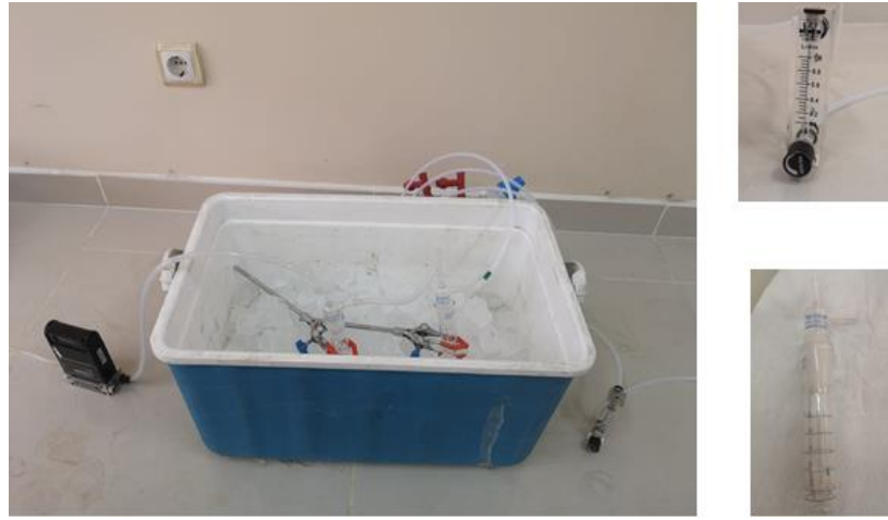
Şekil 4.2: İmpinger örnekleme düzeneği (Air Toxic metodu)
