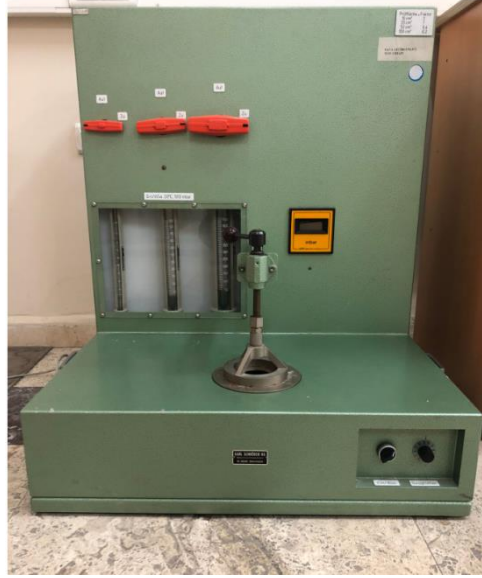
Şekil 4.3: Hava geçirgenliği ölçüm cihazı
