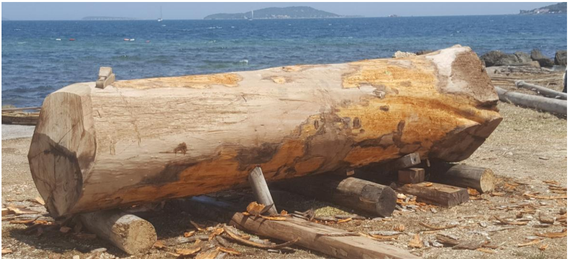
Levha 9: Tomruğun Üzerindeki Kabuğun Soyulması Çalışmaları
