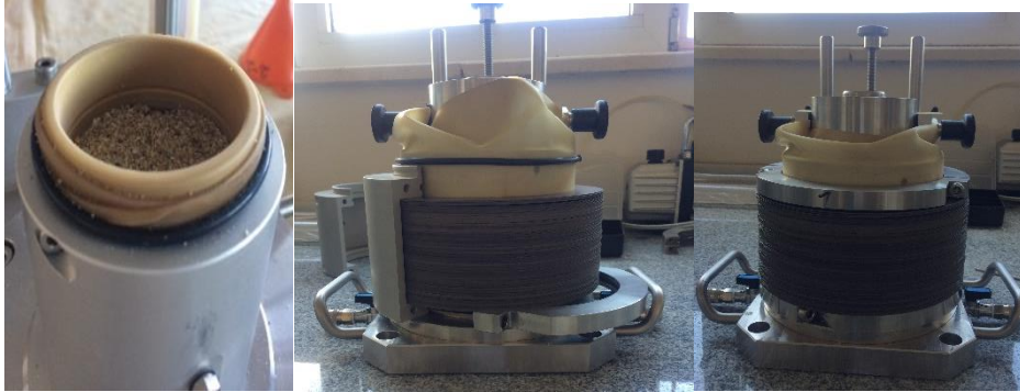
Şekil 4. 20: Sıvılaşma deneyleri için numune hazırlama aparatı ve bazı işlem aşamaları (kumlarda deney örneği hazırlanmasına örnek)
