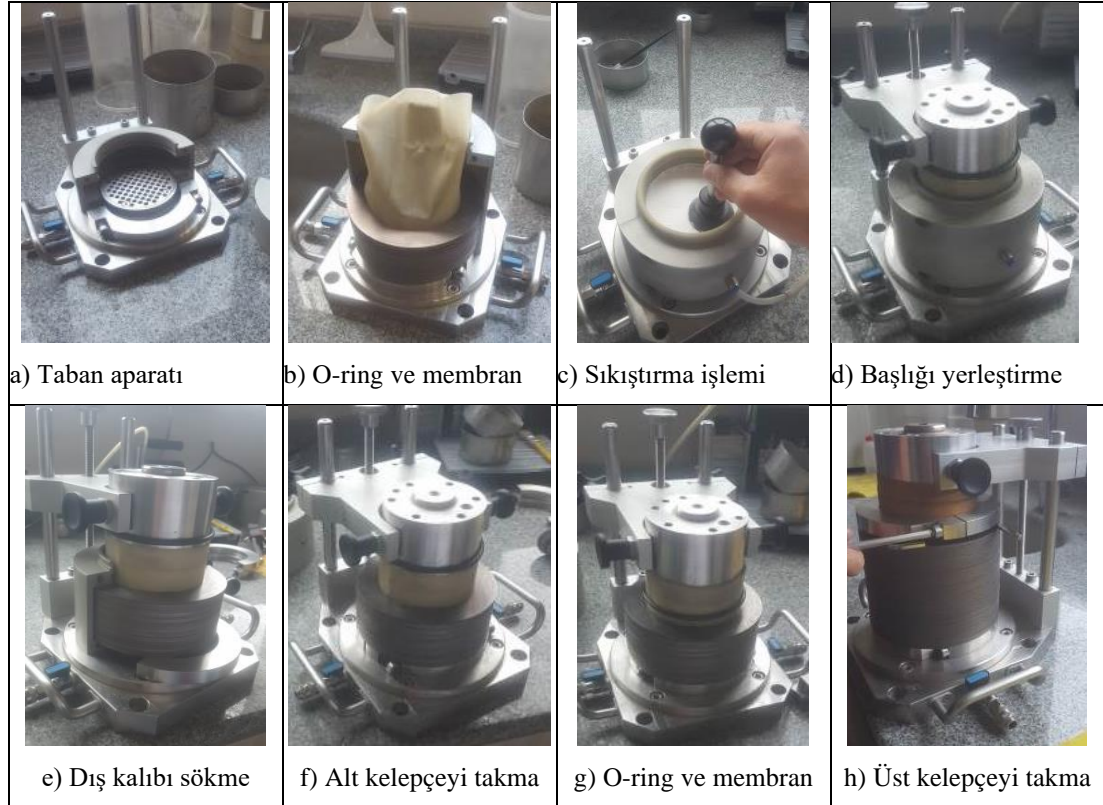
Şekil 4.21: Sıvılaştırma deneyleri için numune hazırlama aparatı ve bazı işlem aşamaları (siltlerde deney örneği hazırlanmasına örnek)
