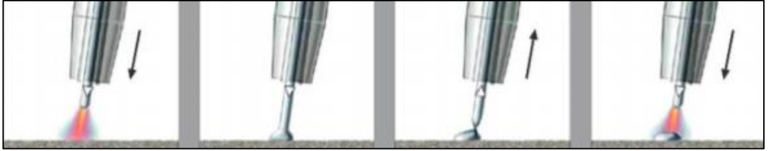
Şekil 4.10: CMT kaynak yönteminde kaynak teli hareketi (Kahraman 2018)
