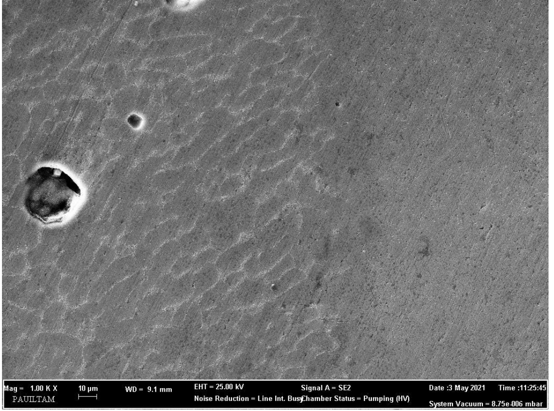
Şekil 8.57: C3 numaralı numunenin 1000 x büyütmedeki ITAB bölgesi Mg 2 Si oluşumu
