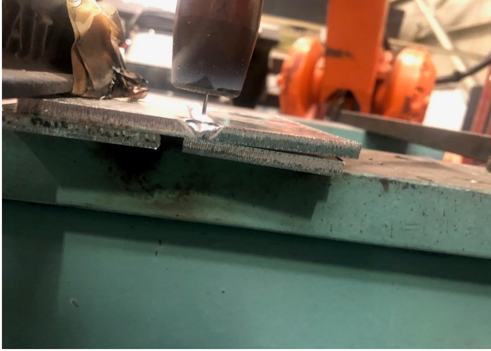
Şekil 7.18: CMT kaynak robotu ile gerçekleştirilen birleştirmeler
