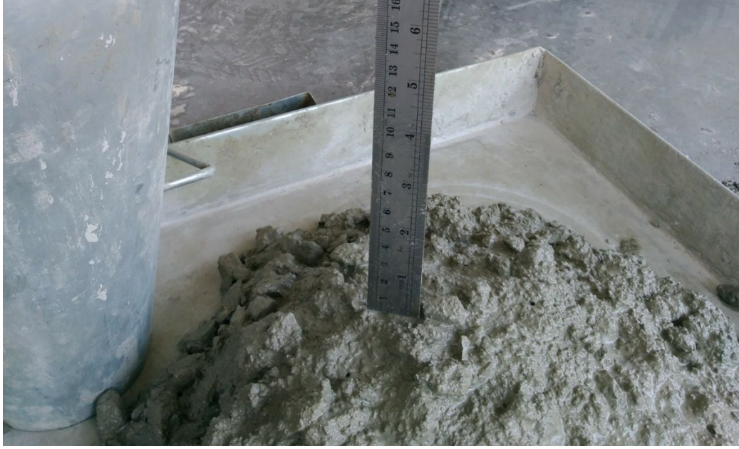
Şekil 3. 2: Reçeteye göre bakteri kültürü eklenen taze beton karışımının fiziksel özelliklerinin kontrolü
