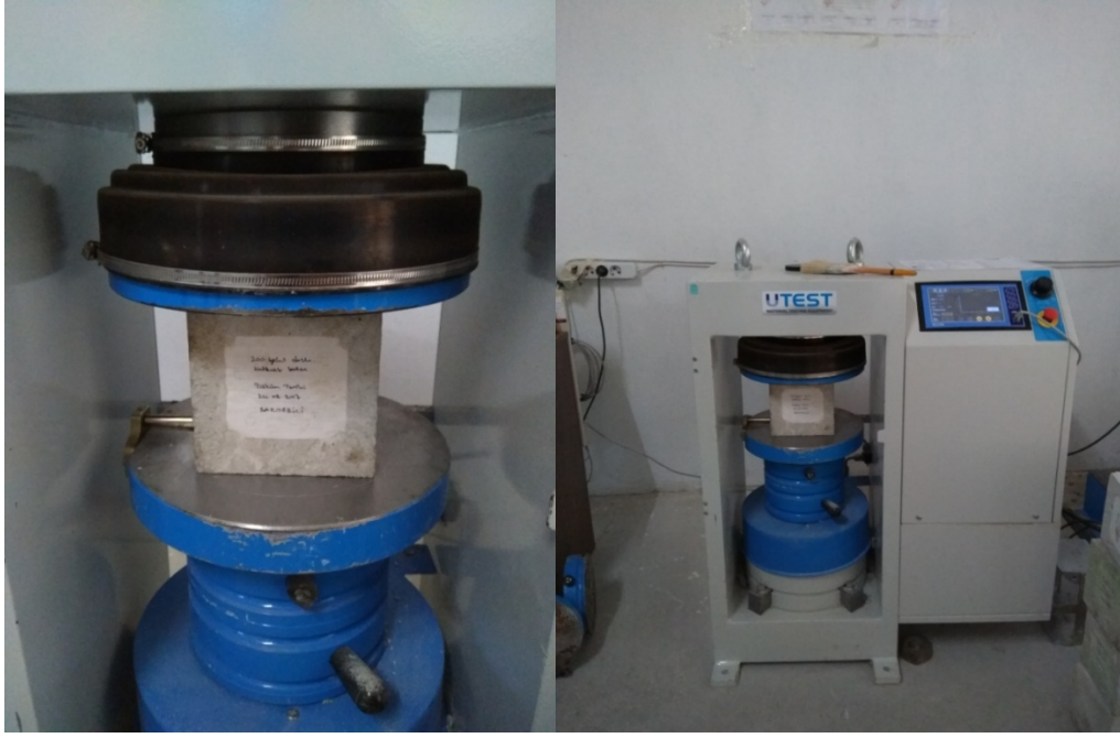
Şekil 3.5: Basınç Dayanımı Testi
