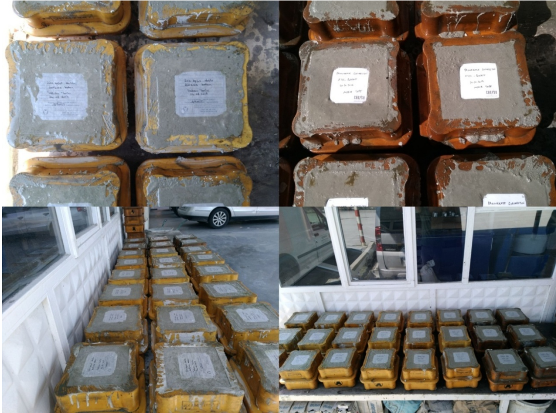
Şekil 3.3: TS EN 206'ya uygun hazırlanan karışımların TS EN 12350-1 standardına uygun olarak kalıplara dökülmesi
