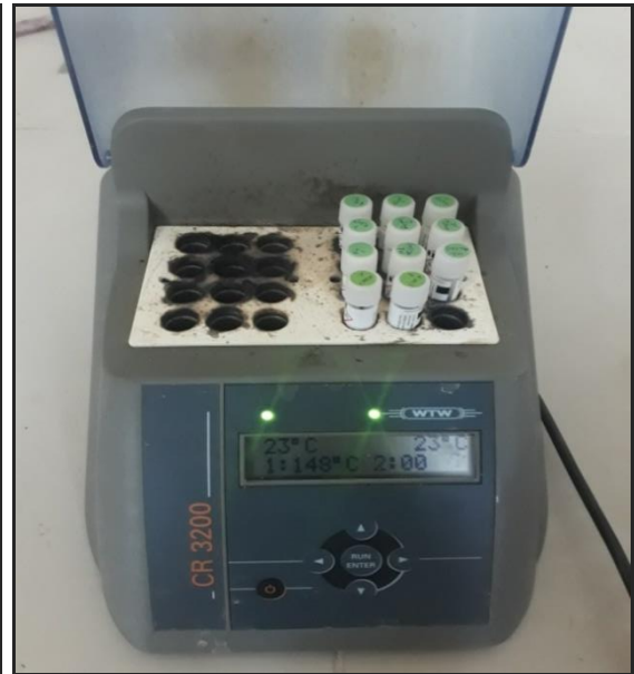
Şekil 2.8: KOİ kitlerinin termoreaktördeki görüntüsü.
