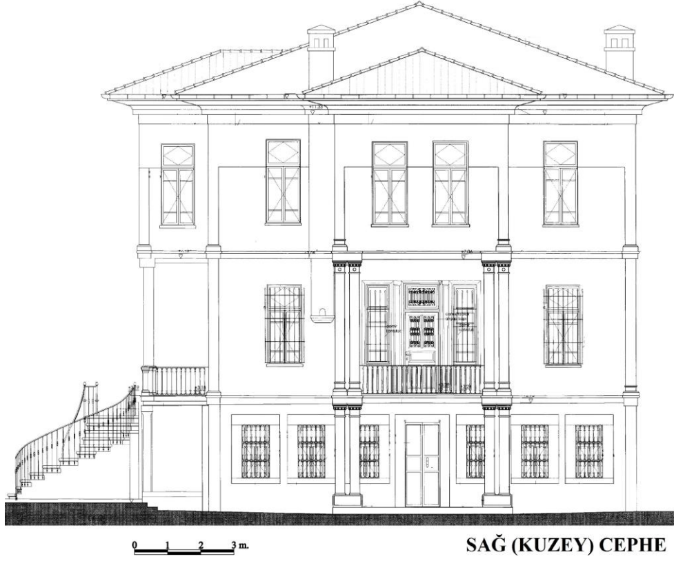
Şekil 99: Paşa Konağı Kuzey Cephesi (SKVKBK-Metin Keskin Mimarlık)
