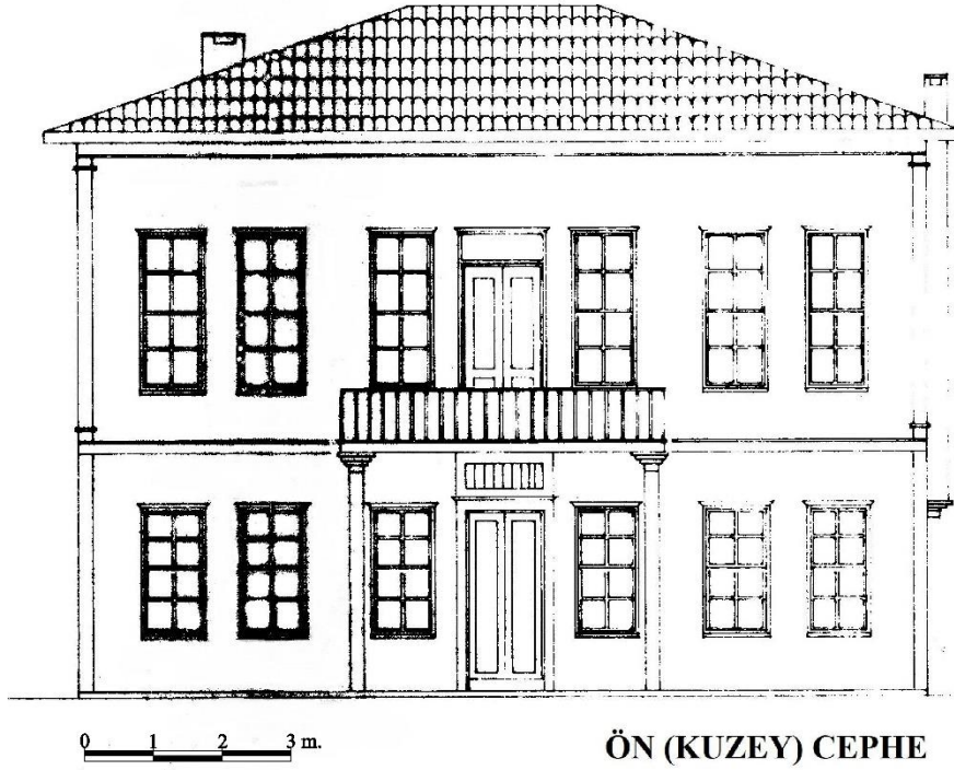
Şekil 323: Ahmet Özder Evi Kuzey Cephesi (SKVKBK-Parmak Mimarlık)
