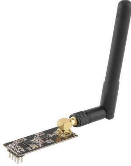
Şekil 3.3: Master 'de Kullanılan NRF24L01 Wi-Fi Modülü
