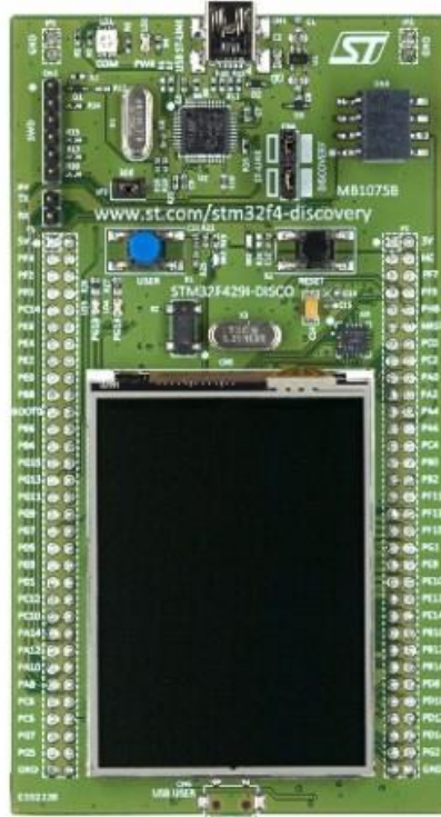
Şekil 3.5: Araçta Kullanılan STM32F429 Discovery Modülü
