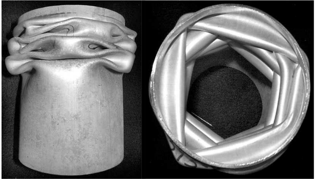
Şekil 2. 2: Alüminyumun alaşımının enerji sönümlemesi (Dündar ve diğ. 2002)
