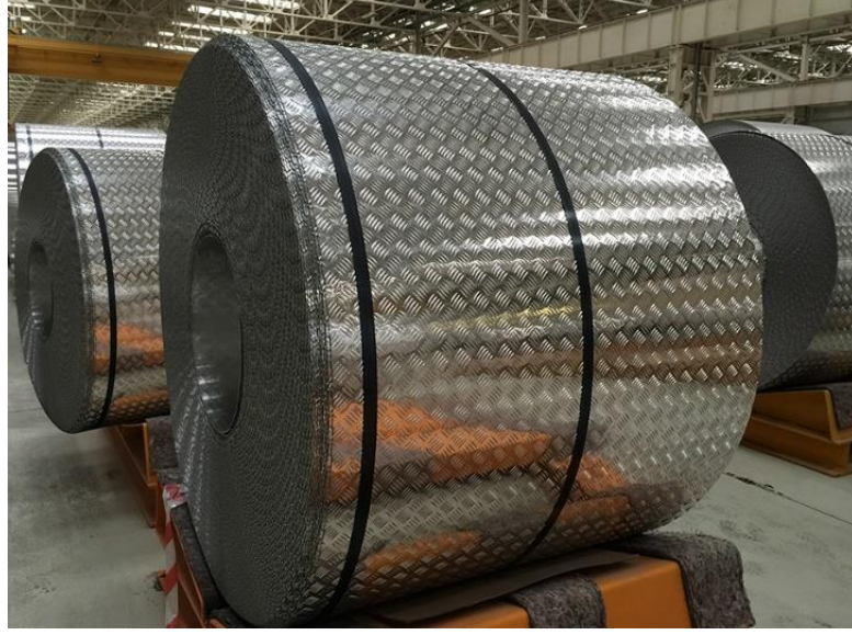
Şekil 2. 6: 5754 alüminyum alaşımından imal edilen çeta sacı
