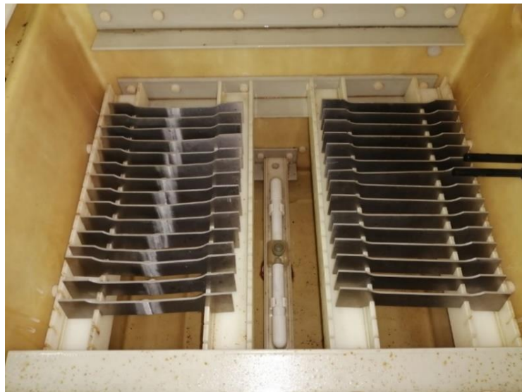
Şekil 5. 18: Numunelerin numune rakına yerleştirilmesi
