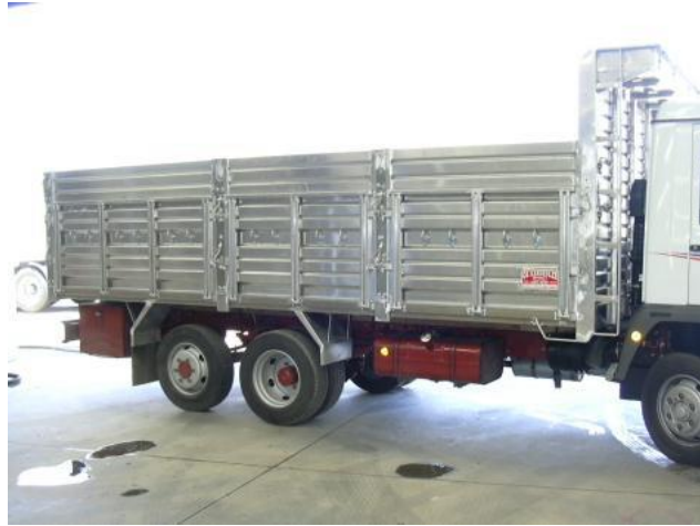
Şekil 2. 4: 5754 alüminyum alaşımından imal edilen kamyon kasası (Dündar ve diğ. 2002)
