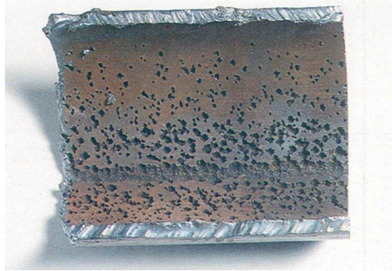
Şekil 3. 16: Kavitasyon korozyonu örneği (URL 11)
