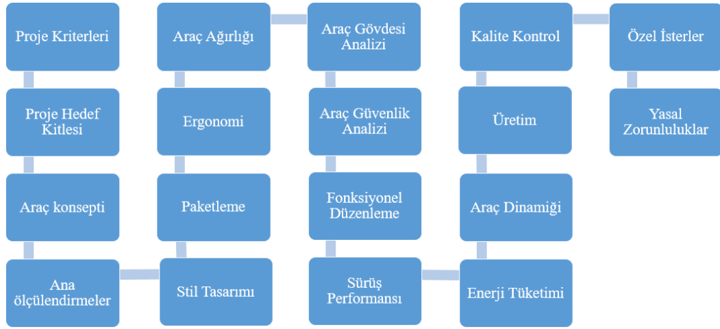
Şekil 4.1: Otomotivde konsept geliştirme döngüsü
