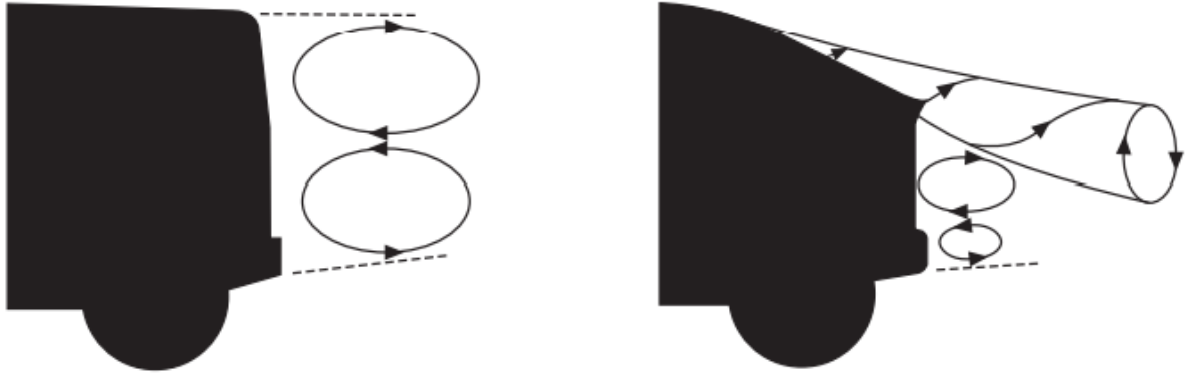
Şekil 5.8: Hatchback ve sedan araçların arka akış ayrımları (Julian, 2002)
