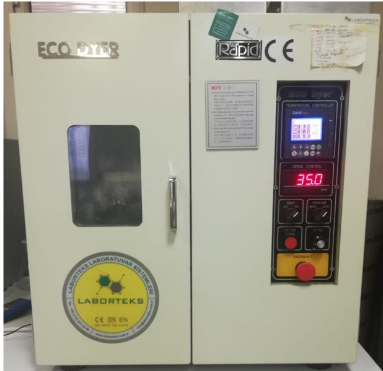
Şekil 6.14: Mikrokapsüllerin kumaşlara aplikasyonunda kullanılan boyama makinesi (Ozanteks Tekstil Laboratuvarı)
