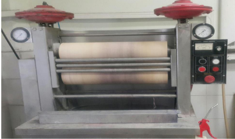
Şekil 6.13: Mikrokapsüllerin kumaşlara aplikasyonunda kullanılan dikey fulard makinesi (Ozanteks Tekstil Laboratuvarı)
