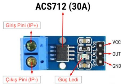
Şekil 4.44: ACS-712 akım sensörü
