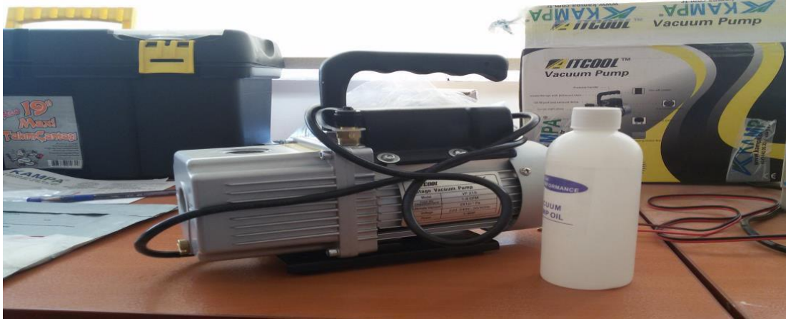
Şekil 4.32: Aitcool VP215 çift kademeli yağlı vakum kompresörü
