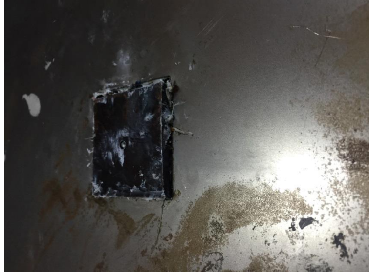
Şekil 4.14: Bakır ısı transferi plakasının (A-204 ) test ortamında kalan kısmı
