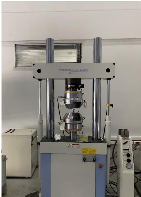
Resim 12 SHIMADZU marka EHF-EV200k2-040-0A model nolu çekme cihazı
