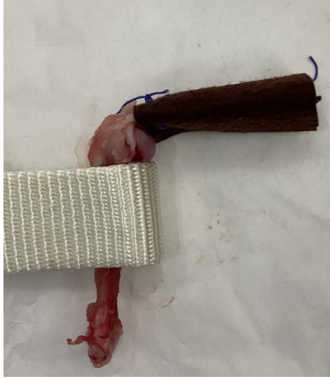
Resim 11 Çekme cihazına yüklenmeden önce kemik-tendon ünitesi
