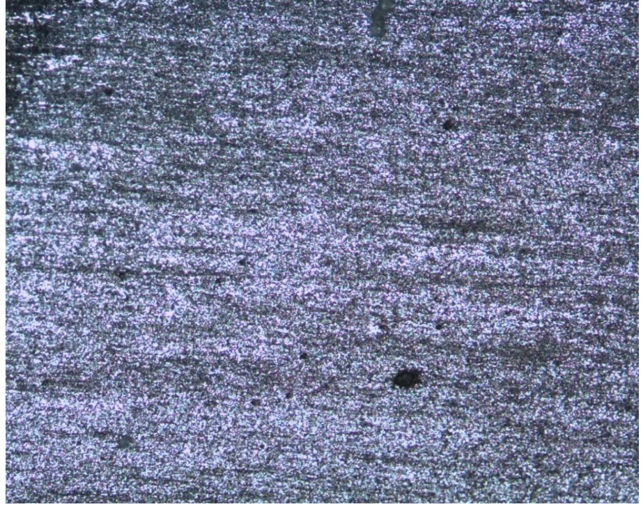
Şekil 4.19: ITAB bölgesinin 100X görüntülenmesi
