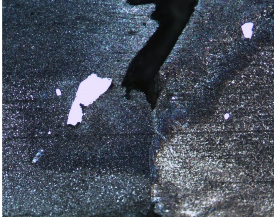
Şekil 4.22: 1500 min -1 ve 150 mm/min parametresi ile SKK yapılan numunenin mikro yapı görüntüsü çatlak başlangıcı
