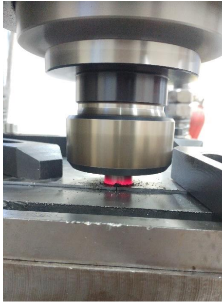
Şekil 3.13: Sabitleme ekipmanları ile sabitlenmiş levhalarda kaynak işleminin başlangıcı
