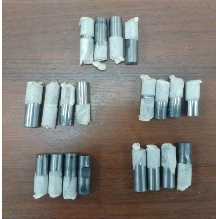
Şekil 3.6: Sürtünme karıştırma kaynağı yapan çift tarafi üçgen pin olarak açılmış takımlar
