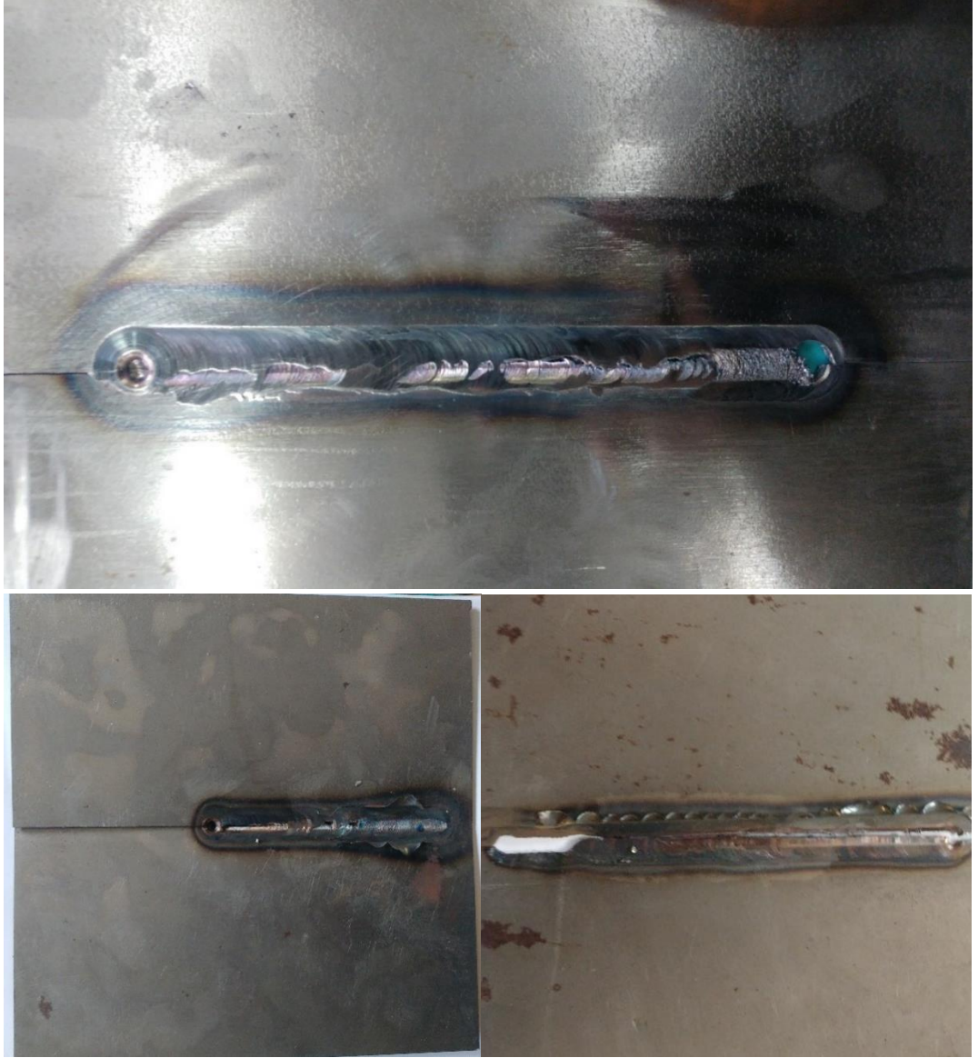
Şekil 3.14: Deneş parametreleri belirlenirken yapılan ön alıřmalardaki yapılmıř hatalı kaynaklar
