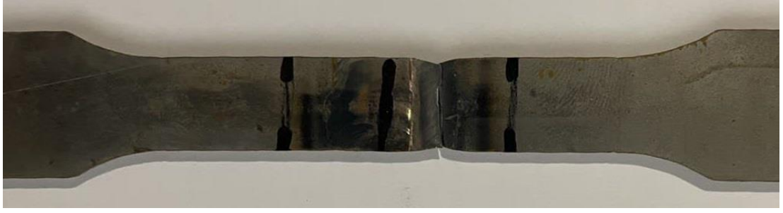
Şekil 4.15: 1180 min -1 ve 75 mm/min parametresi ile SKK yapılan numunenin çekme deneyi sonucu kopma bölgesi
