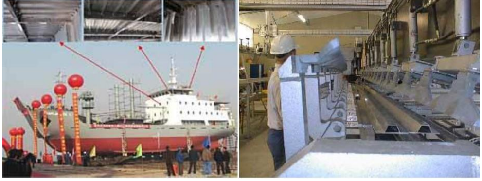
Şekil 2.5: SKK Gemilerde Uygulanması ve Alüminyum Gemi Panellerini Kaynak İçin Kullanılan Sürtünme Karıştırma Kaynak Makinesi (bilginform.com 2021)
