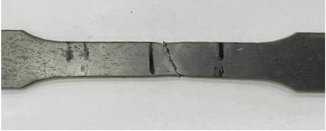
Şekil 4.1: Çalışmada kullanılan DP1000 çelik malzemenin çekme deneyi sonucunda kopma bölgesi
