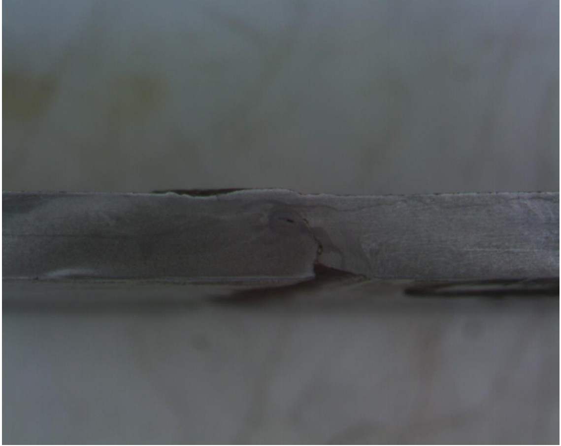
Şekil 4.21: 1500 \text{ min}^{-1} ve 150 \text{ mm/min} parametresi ile SKK yapılan numunenin makro yapı görüntüsü
