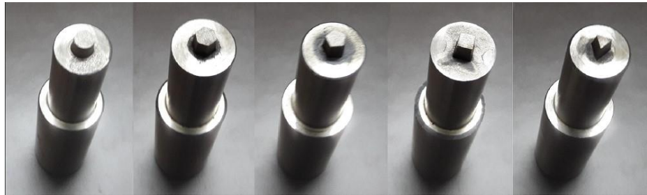
Şekil 2.1: Sürtünme karıştırma kaynak takımları (Miranda 2013)
