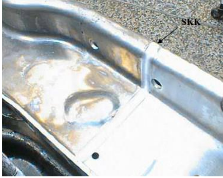
Şekil 2.7: Sürtünme karıştırma kaynağı ile imalatı yapılan kaynak dikişli sac (ESAB 2004).
