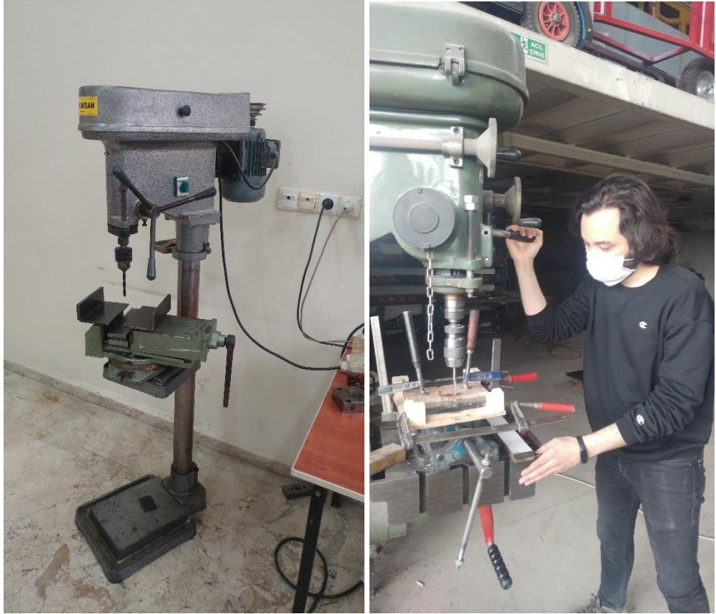
Şekil 3.7: Levha Delik Delme Ekipmanı
