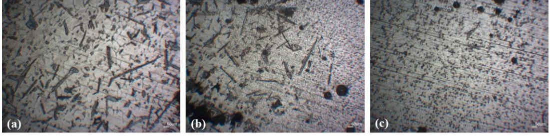
Şekil 6-34: CMT kaynağı ile 110 A'de ER5183 kaynak teli ile birleştirilmesi yapılan %0,5 takviyeli kompozit malzemenin mikroyapı görüntüleri, (a) esas malzeme, (b) geçiş bölgesi, (c) kaynak bölgesi
