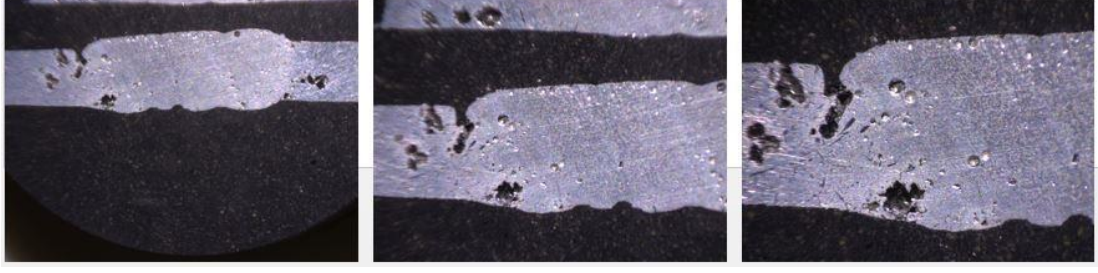
Şekil 6-33: CMT kaynağı ile 110 A'de ER5183 kaynak teli ile birleştirilmesi yapılan %0,5 takviyeli kompozit malzemenin makroyapı görüntüleri
