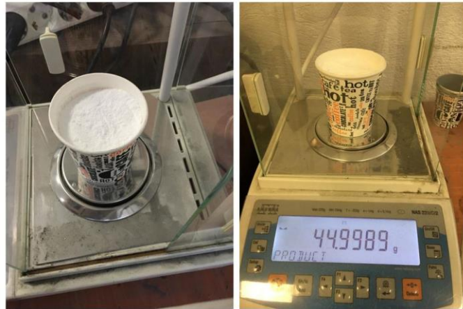
Şekil 5-6: Takviye malzemesinin hazırlanması
