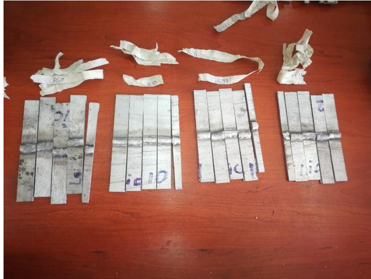
Şekil 5-13: Çekme testi için hazırlanan numuneler
