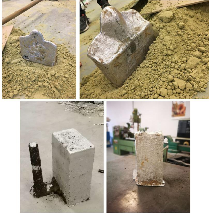
Şekil 5-7: Döküm işlemi ile üretilen kompozit malzemeler
