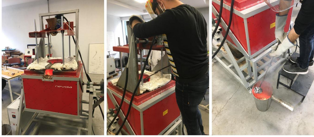
Şekil 5-5: Döküm ocağı ve malzemenin ergitilmesi
