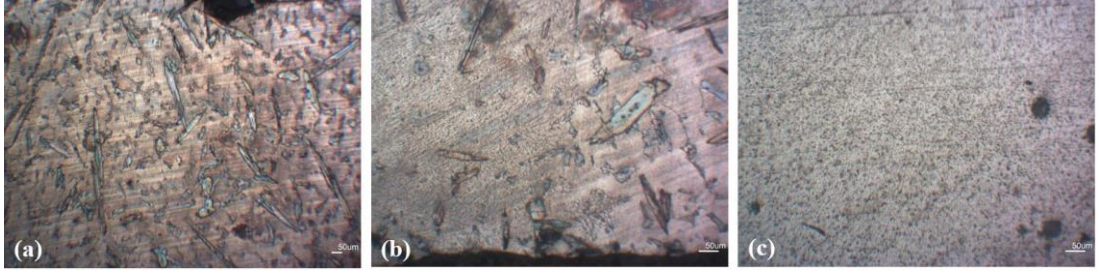
Şekil 6-43: PMC kaynağı ile 110 A'de ER5183 kaynak teli ile birleştirmesi yapılan %0,5 takviyeli kompozit malzemenin makroyapı görüntüleri
