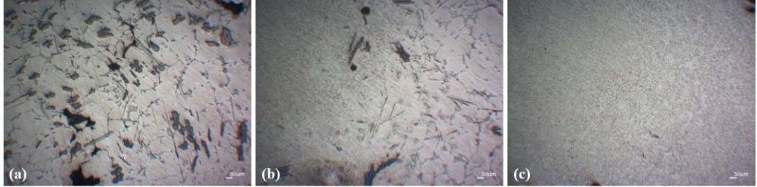
Şekil 6-26: CMT kaynağı ile 120 A'de ER4043 teli ile birleştirilmesi yapılan takviyesiz AA 6013 alaşımının mikroyapı görüntüleri, (a) esas malzeme, (b) geçiş bölgesi, (c) kaynak bölgesi
