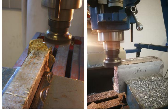
Şekil 5-8: Freze tezgahında talaş kaldırma işlemi
