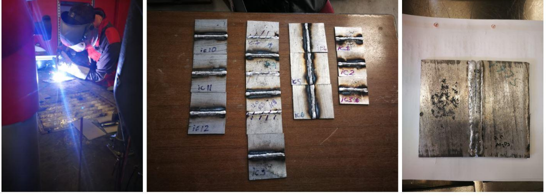
Şekil 5-10: Kaynak yöntemi ile numunelerin birleştirilmesi
