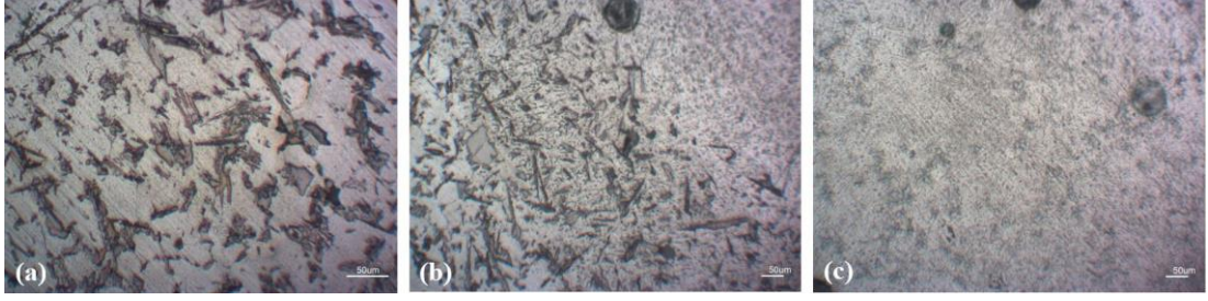
Şekil 6-51: PMC kaynağı ile 120 A'de ER5183 kaynak teli ile birleştirilmesi yapılan %1 takviyeli kompozit malzemenin mikroyapı görüntüleri, (a) esas malzeme, (b) geçiş bölgesi, (c) kaynak bölgesi
