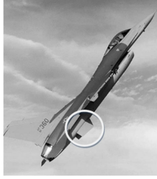
Şekil 2: Metal matrisli kompozitlerden yapılmış F16 gövde arkası kanatları (Onat 2015).
