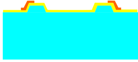
Şekil 4.17: Aşındırılmış cam pul üzerindeki fotodirenç şekillendirilir.
