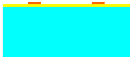
Şekil 4.11: Au üzerindeki fotodirenç şekillendirilir.
