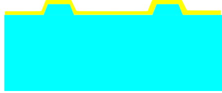
Şekil 4.15: Aşındırılan cam pul üzerine tekrar Au kaplanır.
