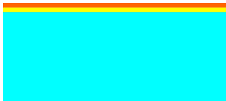
Şekil 4.10: Au üzerine fotodirenç kaplanır.
