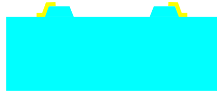
Şekil 4.19: Aşındırılmış cam pul üzerindeki fotodirenç aşındırılarak metal yollar oluşturulur.
