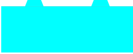
Şekil 4.14: Fotodirenç ve Au aşındırılır.
