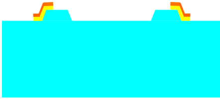
Şekil 4.18: Aşındırılmış cam pul üzerindeki Au aşındırılır.
