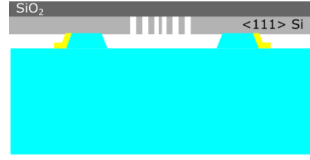
Şekil 4.21: SOI pulun alt yüzeyi DRIE yöntemi ile aşındırılır.
