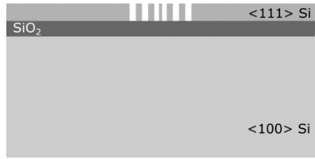
Şekil 4.7: SOI pul DRIE yöntemi ile aşındırılır.
