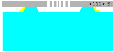
Şekil 4.22: SiO2 tabakası aşındırılır.
