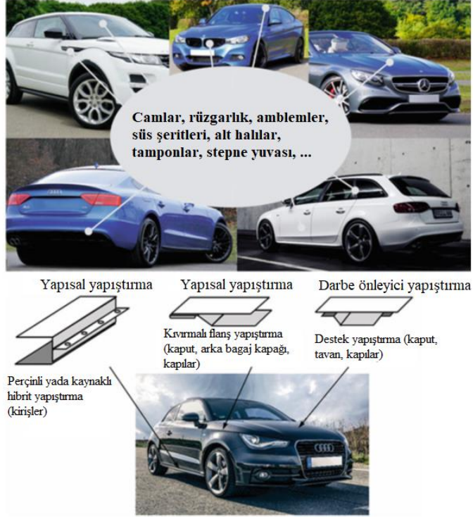
Şekil 2.9 Yapıştırma bağlantıların otomotiv endüstrisindeki kullanım alanları (Pocius 2012).
