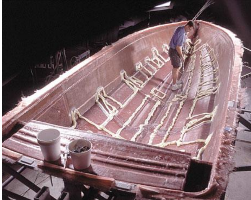
Şekil 2.13 Tekne gövdesinde yapıştırıcı uygulaması (Pocius 2012).
