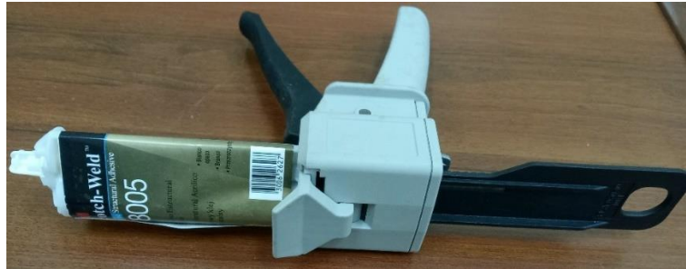
Şekil 4.2 3M DP8005 yapıştırıcının uygulama tabancasına montajlanmış hali.
