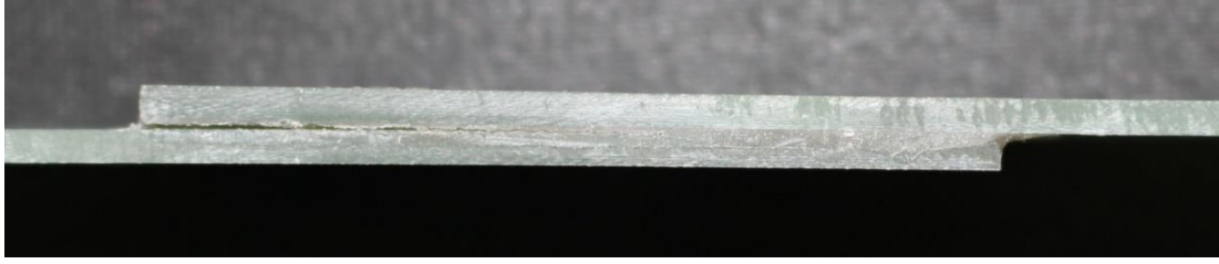
Şekil 5.2 2,5 J ön darbe sonrası AV138 tek yapıştırıcılı bağlantılarda meydana gelen hasar.
