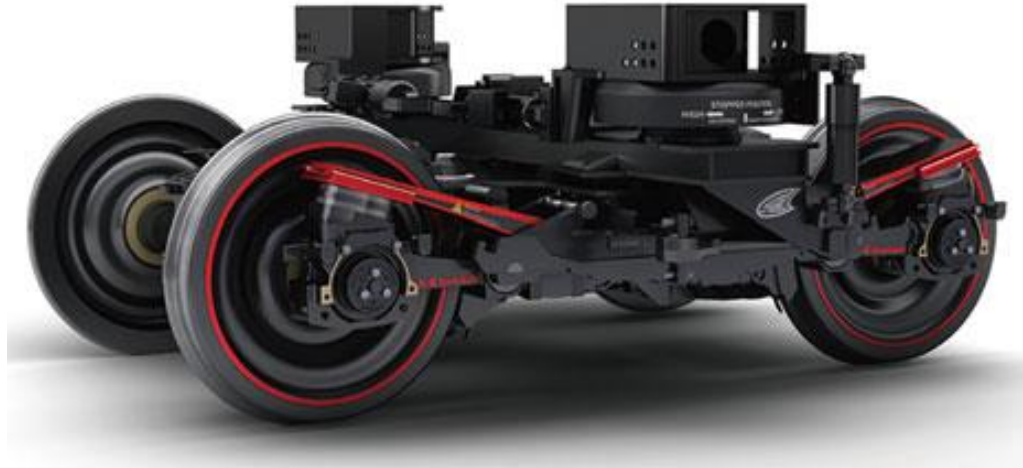
Şekil 2.11 Yapıştırma bağlantıların kullanıldığı boji tasarımı (da Silva ve diğ. 2018).
