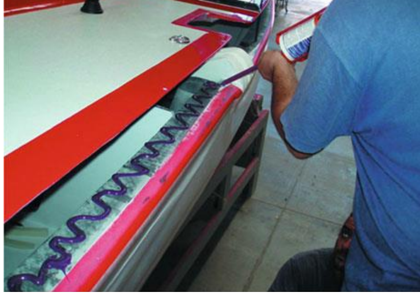
Şekil 2.14 Tekne gövdesine güvertenin yapıştırılması (Pizzi ve Mittal 2018).
