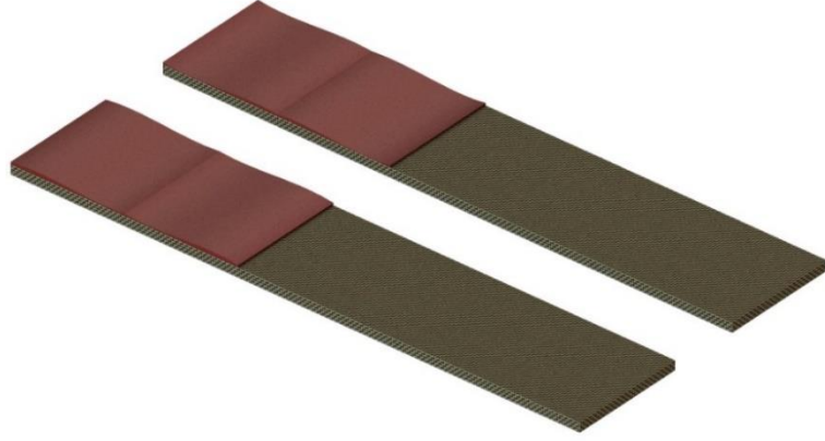
Şekil 2.6 Kohezyon hasarının üç boyutlu modellenmesi.
