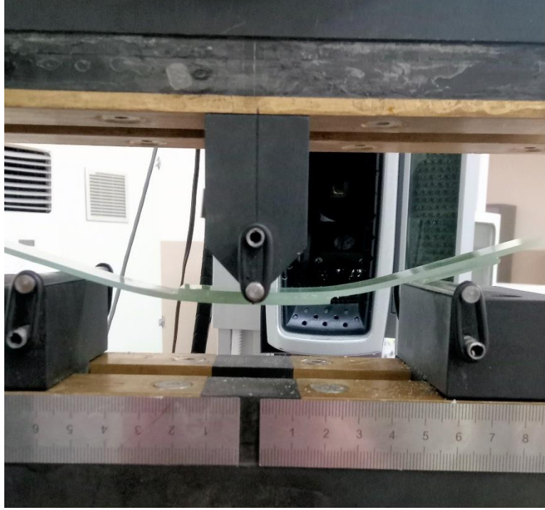
Şekil 4.15 Üç nokta eğilme cihazına yapıştırma bağlantılarının yerleşimi.
