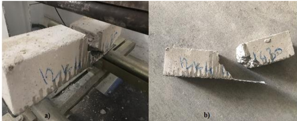
Şekil 5.4: 12K Tek yön kumaş numunesi testi a) Kırılma anı b) Kırılmış numune
