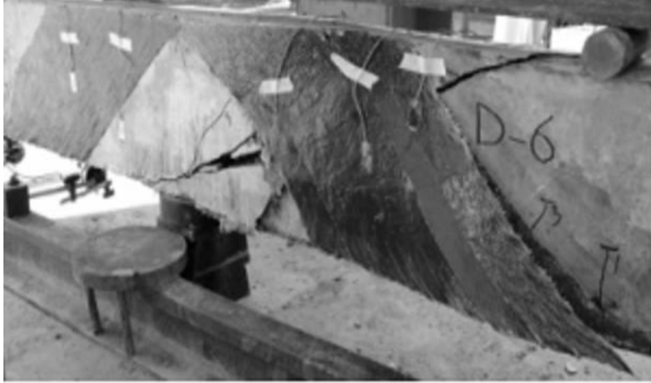
Şekil 3.3: Bukhari ve diğerleri (2010) 45°'lik açı ile CFRP uygulaması deney numunesi sonucu
