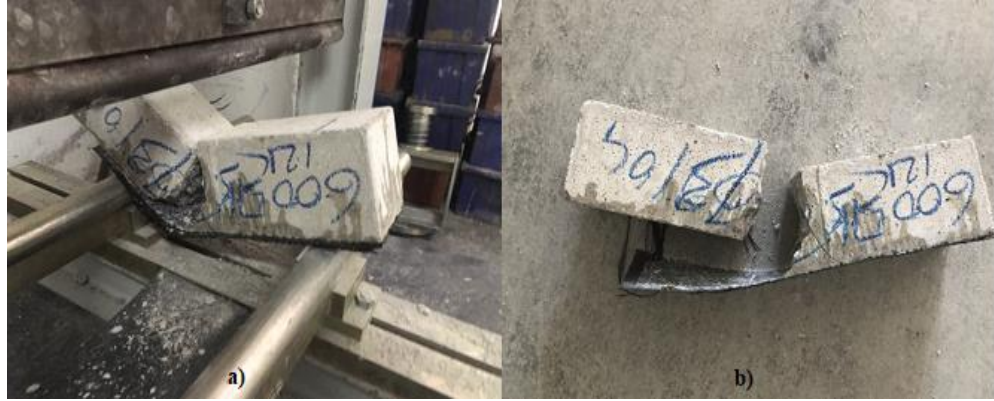
Şekil 5.8 12 K Çift yön numune testi a) Kırılma anı b) Kırılmış numune
