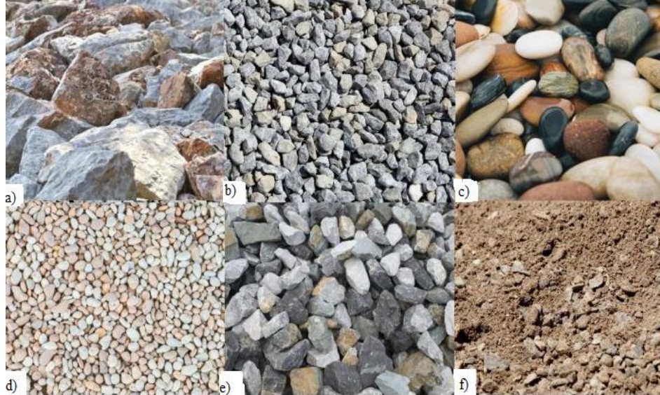
Şekil 1.11: Tiplerine göre agrega çeşitleri a) iri kırma b) ince kırma c) çakıltaş d) ince çakıltaş e) orta kırma f) kum kırmataş karışımı (Url_10)
