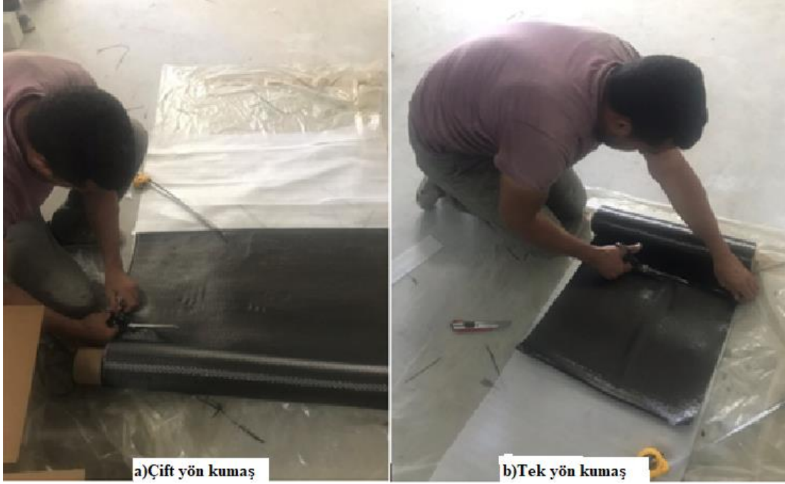
Şekil 4.9: Karbon kumaşların kesimi a) Çift yön kumaş b) Tek yön kumaş
