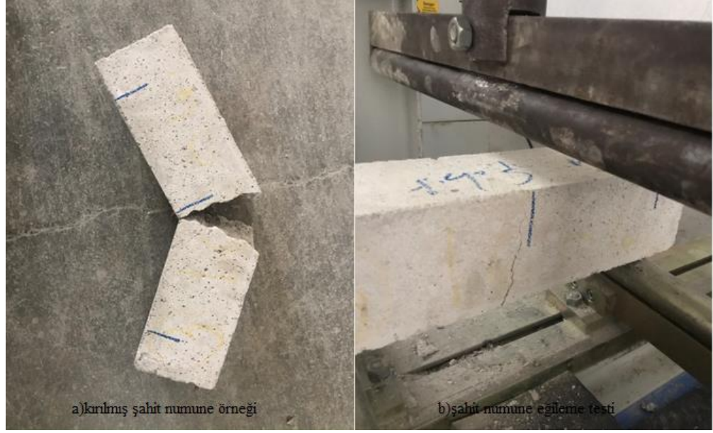
Şekil 5.1: Şahit numune eğilme testi a) Eğilme testi sonucu kırılmış şahit numune örneği b) şahit numune eğilme testi
