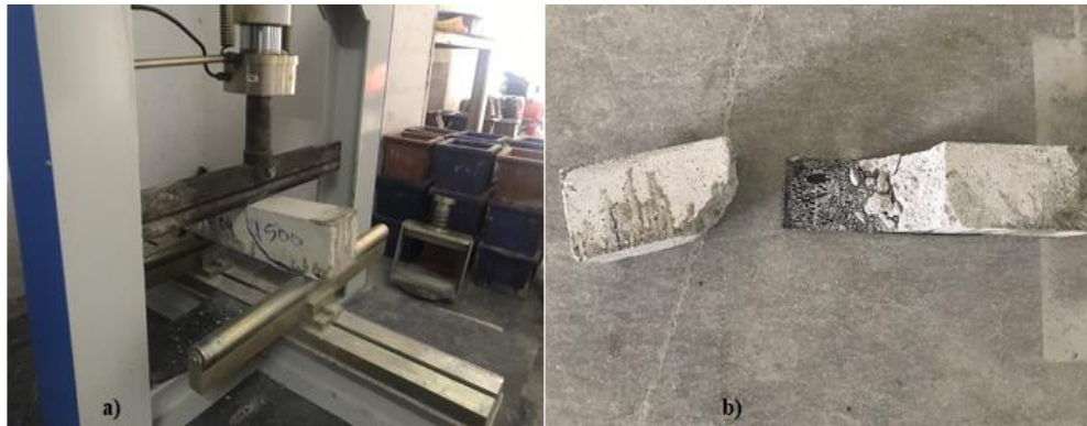
Şekil 5.6: 24 K Tek yön kumaş numunesi testi a) Kırılma anı b) Kırılmış numune
