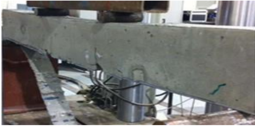
Şekil 3.5: CFRP ile güçlendirilmiş kirişin 4 nokta testi ile eğilme dayanımı ölçümü (Hawileh ve diğ. 2014)
