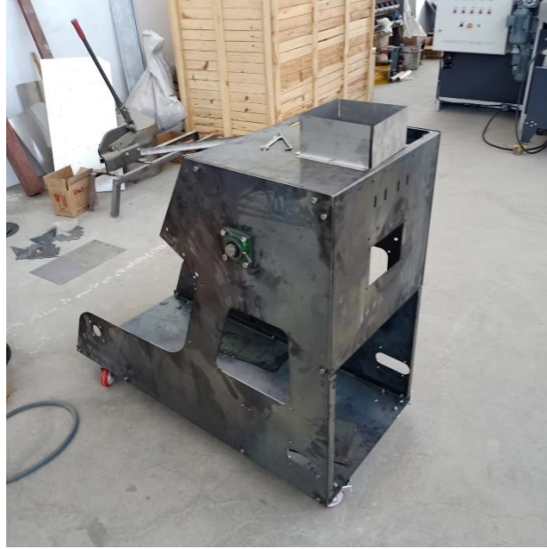
Şekil 16: Makine Dış Şase Montajının Yapılması
