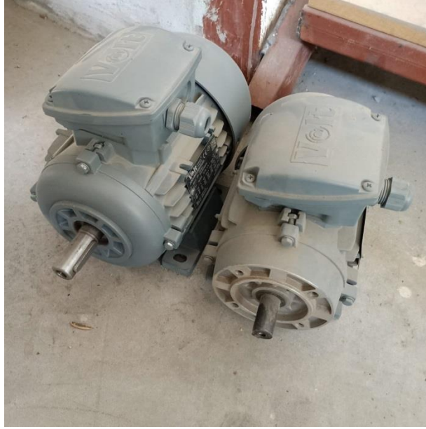
Şekil 4: 3 Fazlı Asenkron Motor
