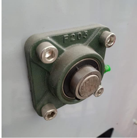
Şekil 6: UCF Tipi Yataklı Döküm Gövde Rulman
