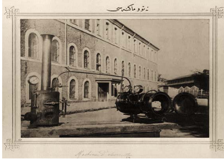
Resim 1: Etüv Makinası, 1880 ile 1893 Arası, İstanbul 13
