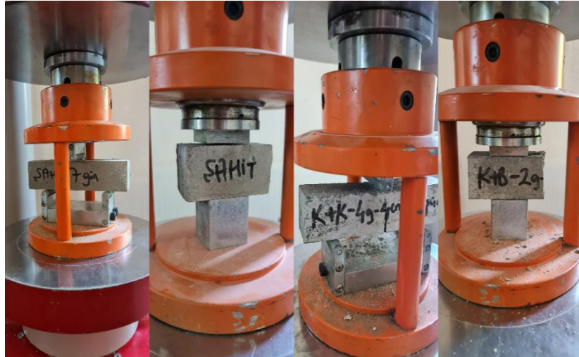
Resim 3.29: Bazı numunelerin beton eğilme ve basınç dayanımı testleri
