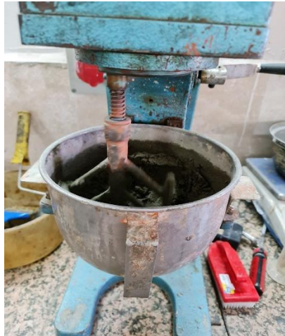
Resim 3.11: Beton harcının homojen olarak karıştırılması için kullanılan mikser
