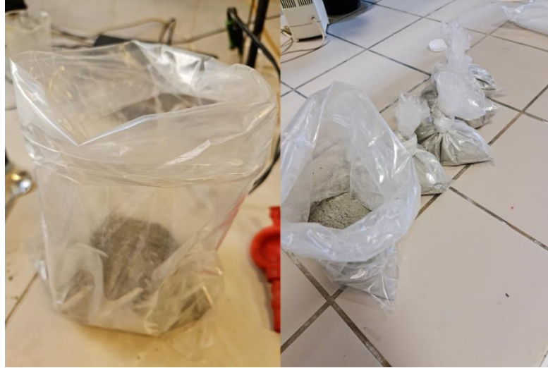
Resim 3.21: Tartım işlemi tamamlanan çimentolar, harç karışımında kullanılmak üzere paketlenmiştir
