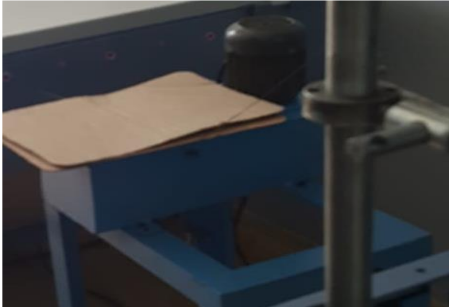
Resim 3.4: Randımansız çalışan kimyasal besleme haznesi
