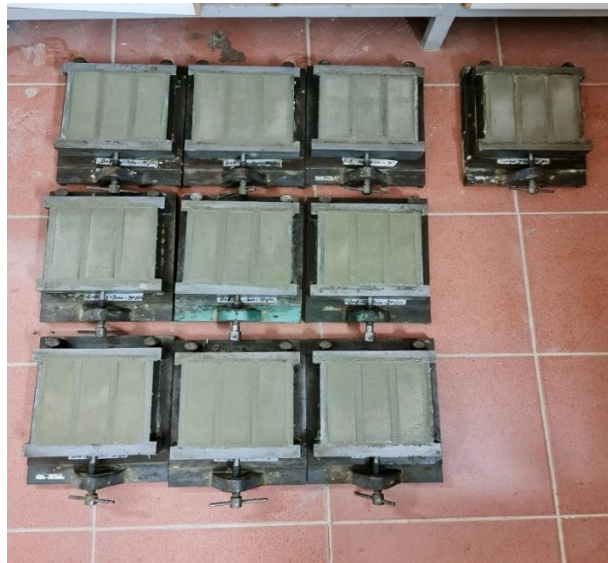
Resim 3.27: Ön kürlenmeye bırakılmış beton kalıpları
