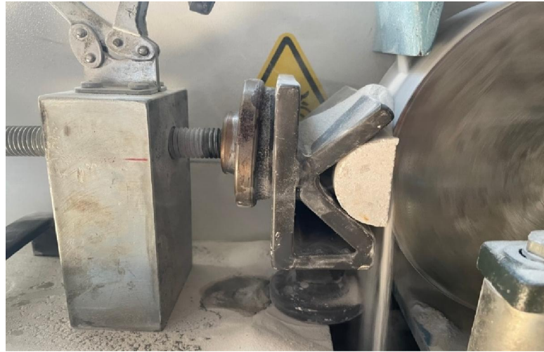
Şekil 4.9: Yarım karot örnek üzerinde aşınma deneyinin gerçekleştirilmesi.
