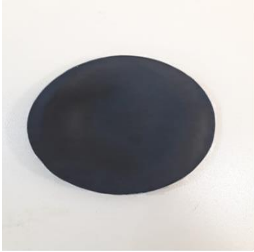
Şekil 4.10: 24 saatin sonunda katılaştıran PLA+karbon fiber karışımı
