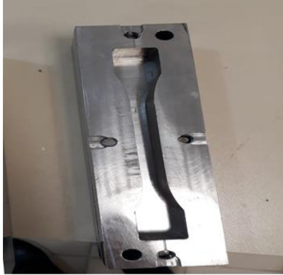
Şekil 4.13: TS EN ISO 527-4'e göre yaptırılan çelik kalıbın görüntüsü
