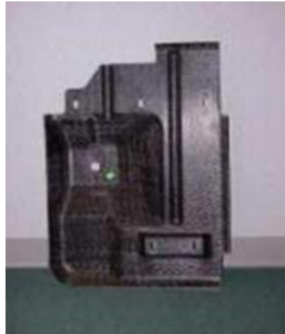
Şekil 3.3: PP – E-Camından üretilmiş motor altı koruyucusu (Belingardi vd.2011).
