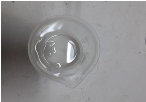
Şekil 4.5: Kloroform ile çözdürülmüş PLA görüntüsü
