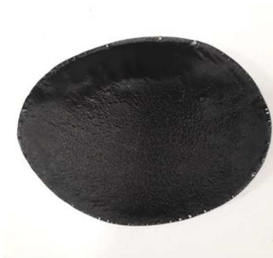
Şekil 4.12: Soljel yöntemiyle üretilmiş gözenekli yapıdaki PLA+Karbon fiber karışımı
