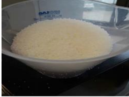
Şekil 4.1: Deneysel çalışmada kullanılan granüler formdaki PLA
