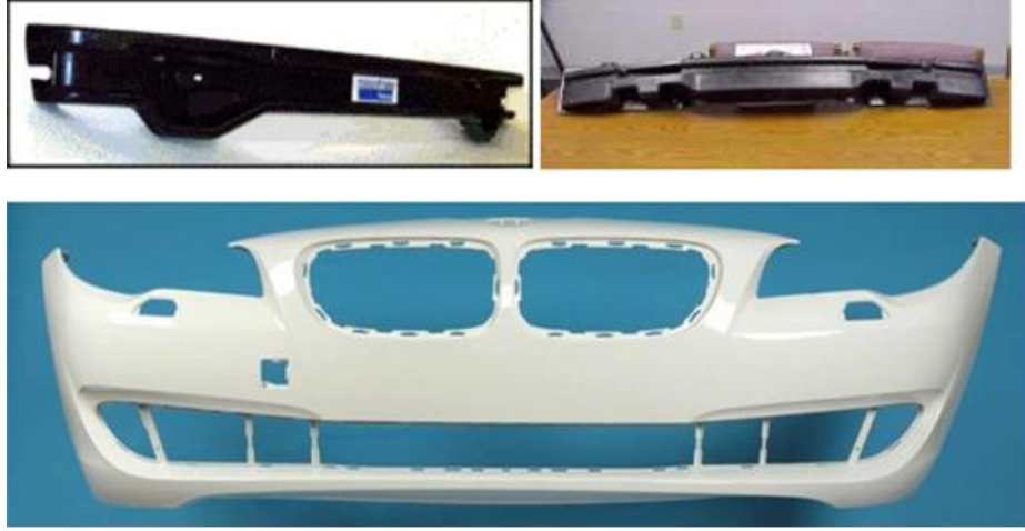
Şekil 3.4: PE matrisli E-Camı fiberlerinden üretilmiş darbe emici tampon bağlantı parçası ve BMW 3 serisi araçlarındaki uygulaması (Belingardi vd.2011).
