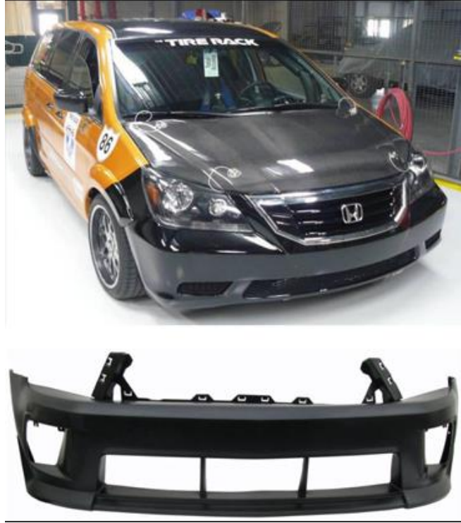
Şekil 3.10: Honda otomobillerinde kompozit ön tampon
