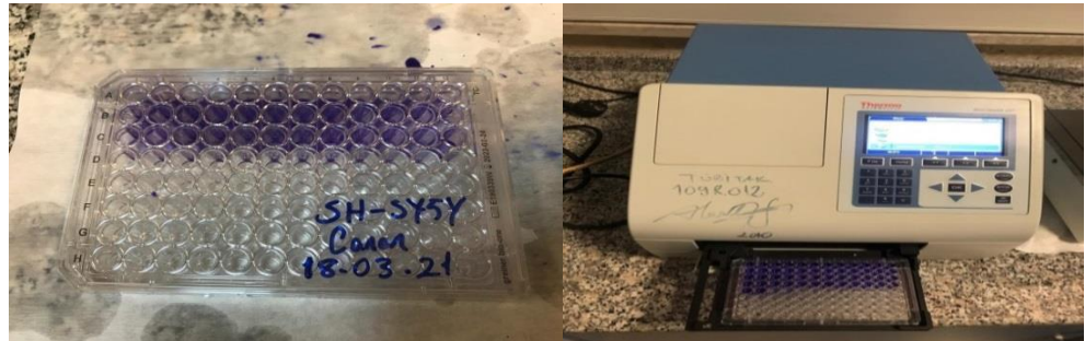
Şekil 3.9: Değişik konsantrasyonlardaki PQQ’un hücre canlılığına olan etkisinin 630 nm’de plaka okuyucuda ölçülmesi.
