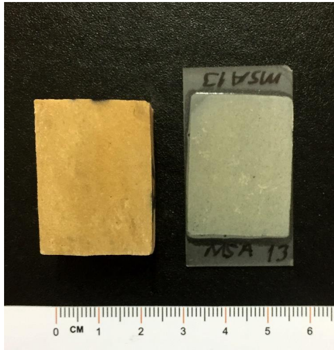
Şekil 3.35: MSA-13 El Örneği, tufa kumu yapısı barındırmaktadır.
