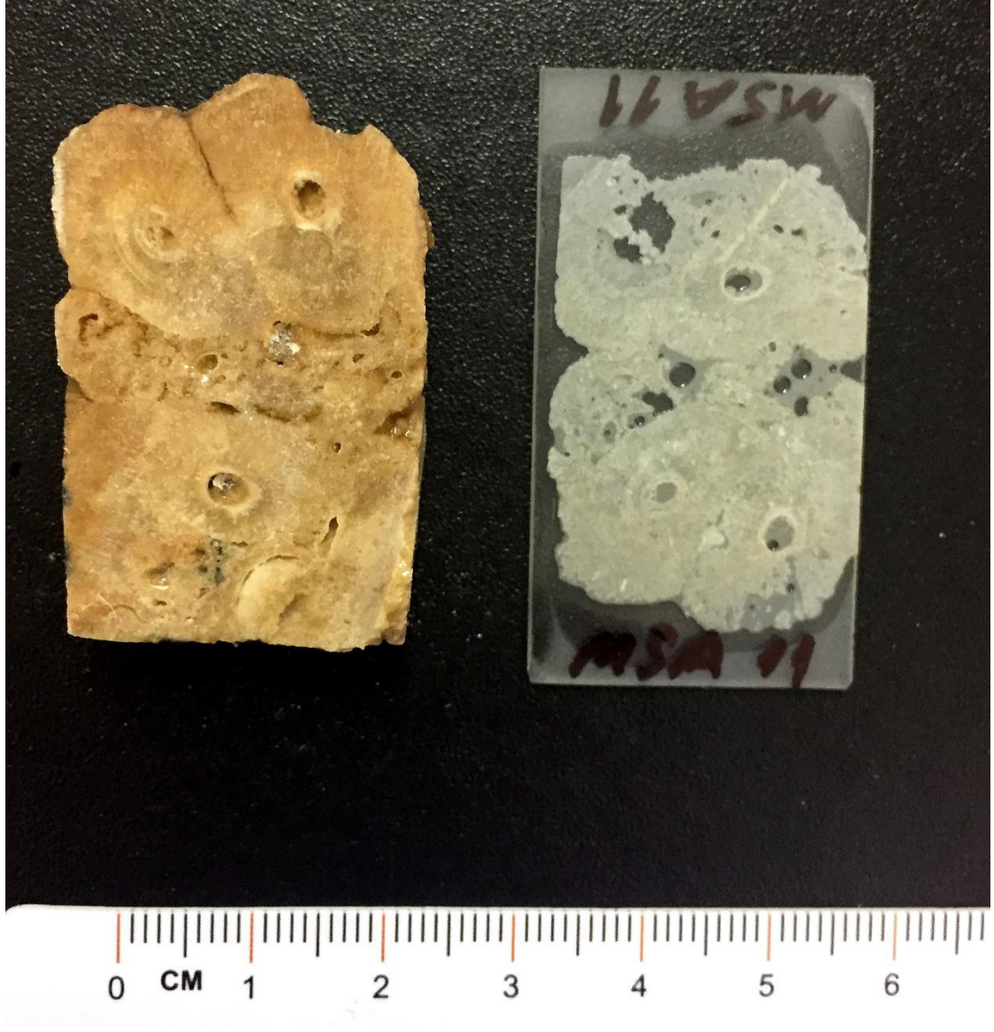
Şekil 3.31: MSA-11 El örneği, bitki gövdesi etrafında oluşan kalsit kabuk ve çimento yapısı görülmektedir.
