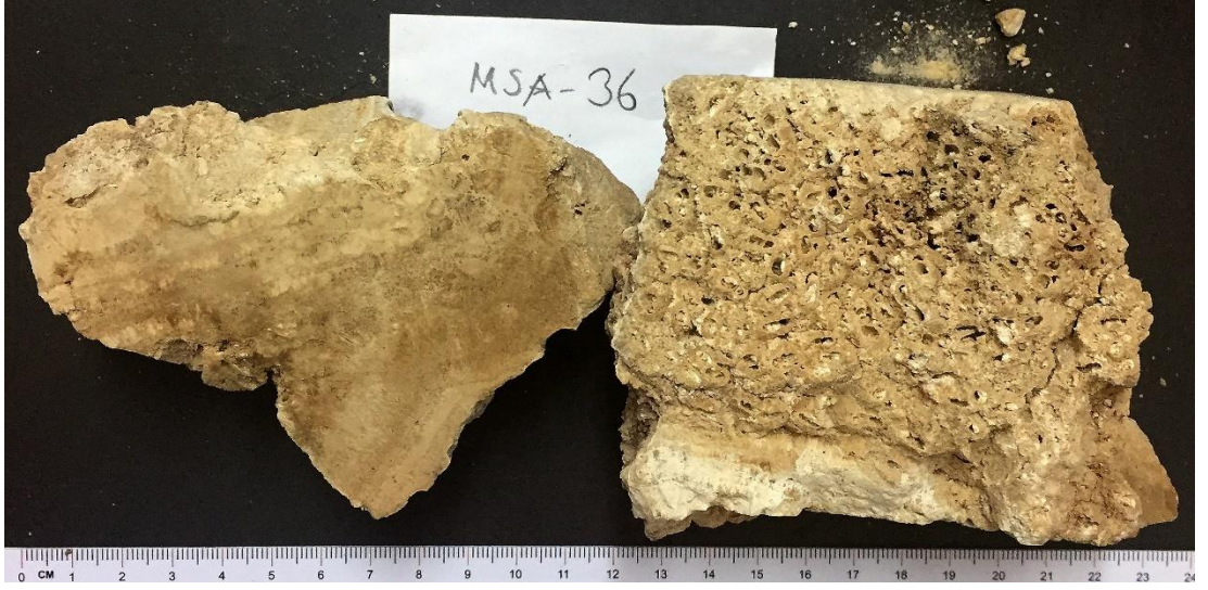
Şekil 3.74: MSA-36 El örneği, lamina ardalanması mevcut ve lamina sınırında oluşmuş larva boşlukları görülmektedir.
