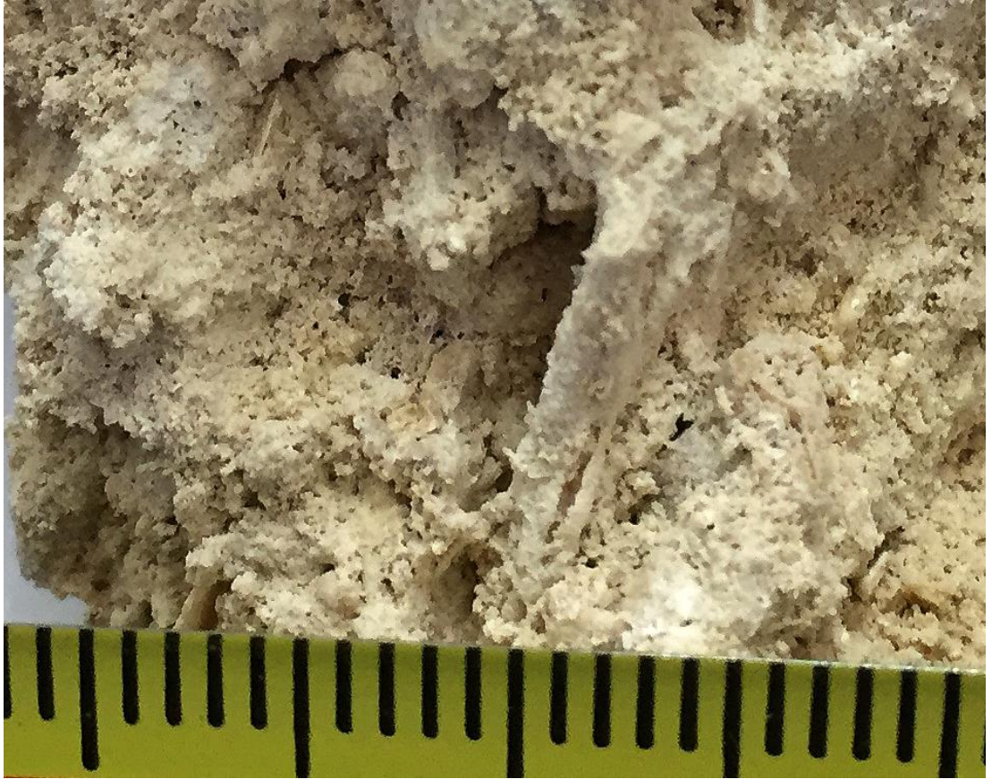
Şekil 3.57: MSA-21 El örneği detay görüntüsü, kum tanelerinin arasındaki bitki parçaları.
