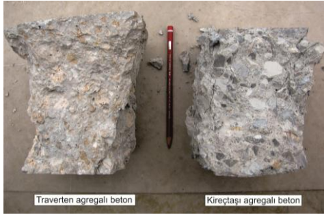
Şekil 5. Traverten ve kireçtaşı agregalı betonlar içinde agregaların dağılımı ve beton numunelerinin genel görünümleri.
