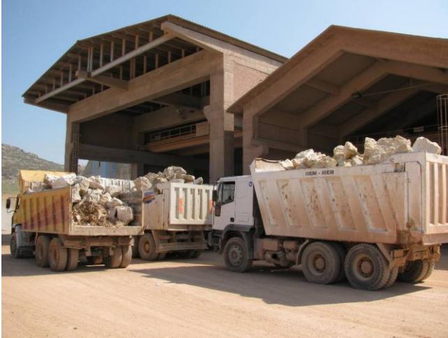
Şekil 2: Çimento hammaddesi olarak değerlendirilmek üzere kırma ünitesine taşınan artıklar.
