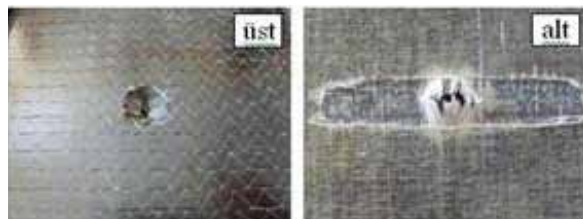
Şekil 11. CG2 hibrit kompozitinin delinme sınırındaki hasarlı numune fotoğrafları.
