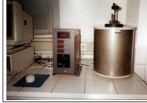
Resim 1. ToniCAL kalorimetresi hidratasyon ölçüm aleti
