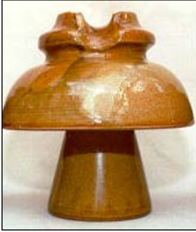
Şekil 6. Hasara uğramış bir porselen izolatör
