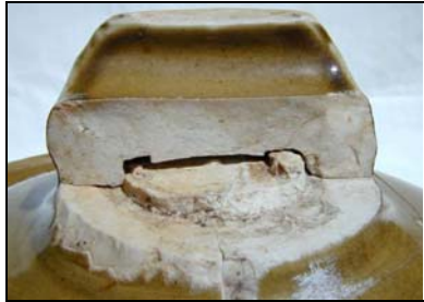
Şekil 7. Üst kısmı hasara uğramış bir porselen izolatör
