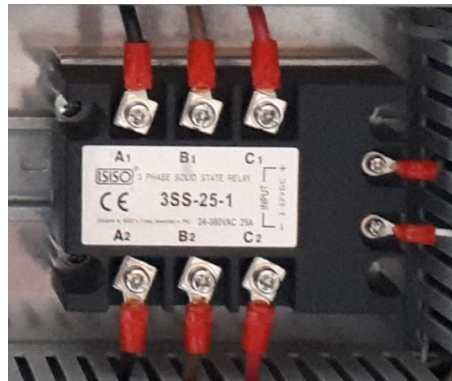
Şekil 3.40: Isıtıcı anahtarlama için kullanılan SSR.
