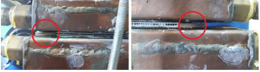
Şekil 4.5: TEG koruması için kullanılan tampon malzemeler.
