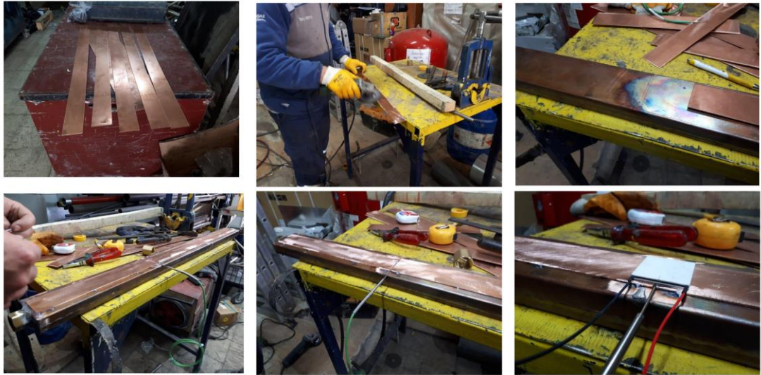
Şekil 3.24: Bakır profil yüzeyine lama ve TEG montajı.
