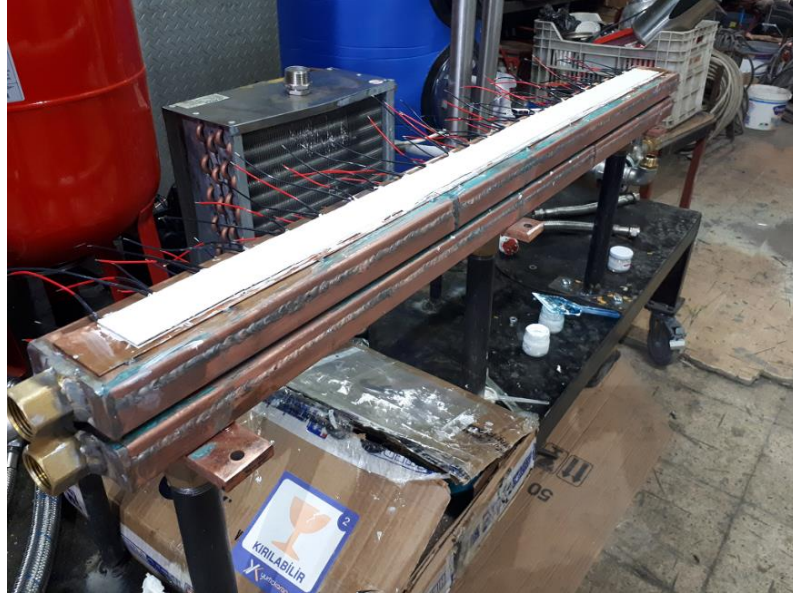
Şekil 3.30: TEG'lerin sıcak su taşıyan bakır profil üzerine yerleştirilmesi.
