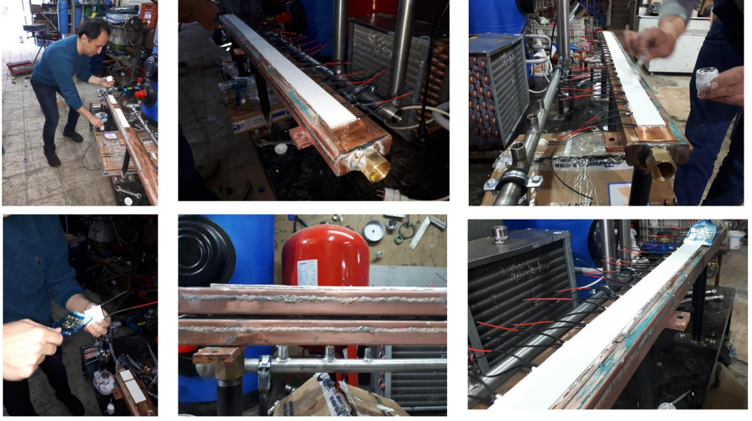
Şekil 3.28: TEG yüzeylerine termal macun sürülmesi.
