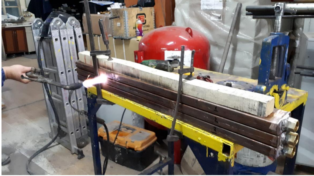
Şekil 3.23: Bakır profil yüzeyinin düzleştirilmesi.
