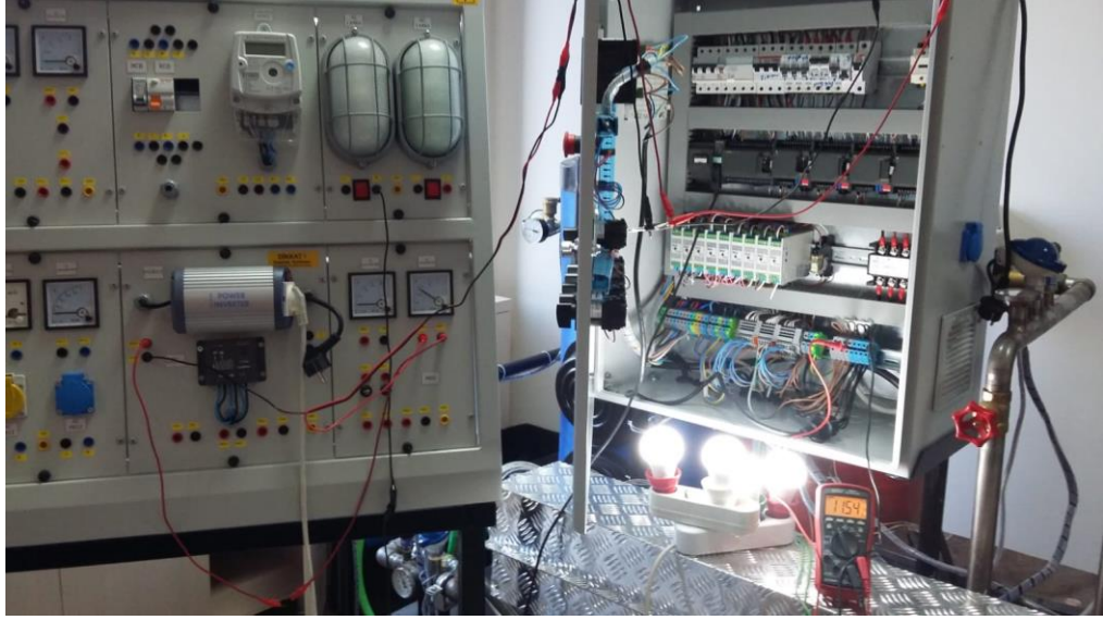
Şekil 4.6: TEG sisteminin LED lambalar ile yüklenmesi.
