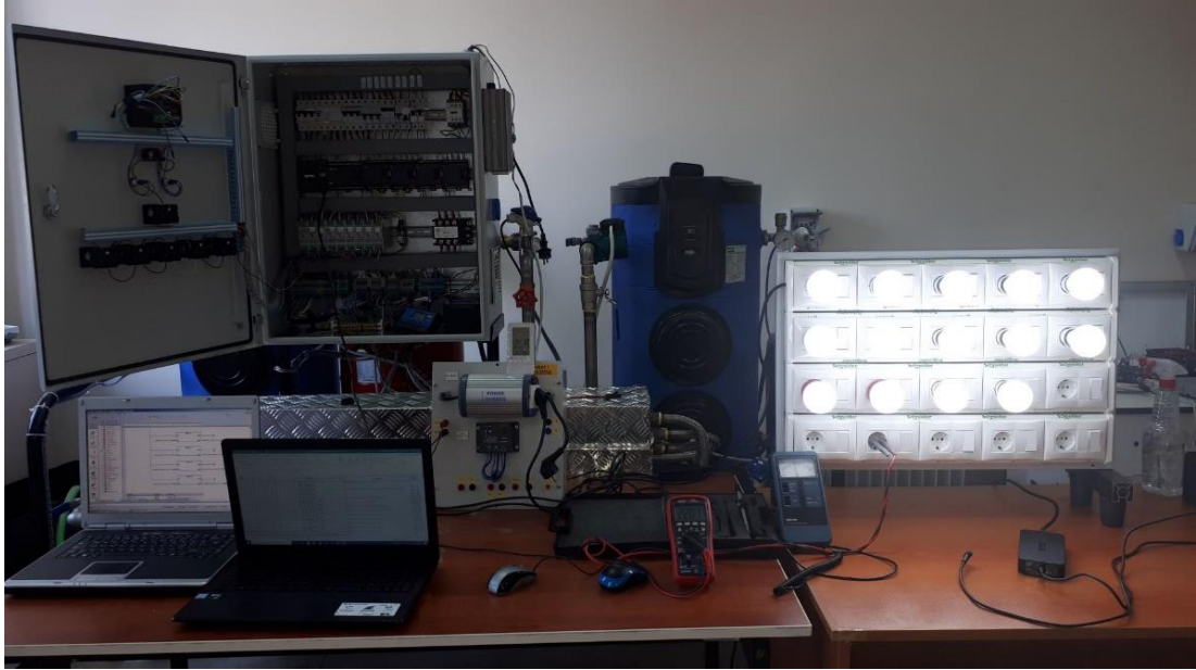
Şekil 4.10: TEG sisteminde AC yüklerin enerjilendirilmesi.
