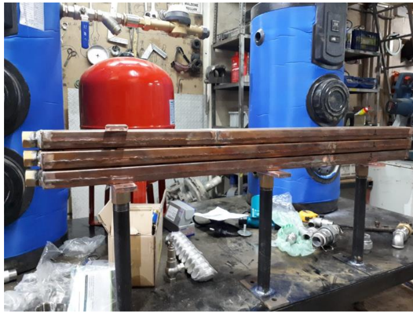
Şekil 3.25: Isı transferi için kullanılan zig-zag bakır şeritler.
