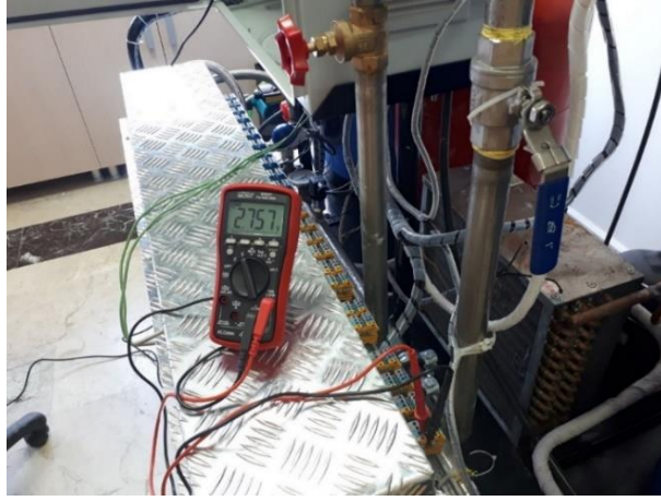
Şekil 4.2: TEG sisteminde modül çıkışlarının ölçülmesi.
