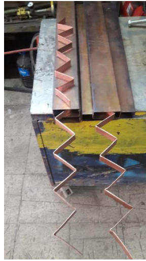
Şekil 3.25: Isı transferi için kullanılan zig-zag bakır şeritler.
