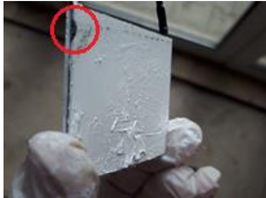
Şekil 4.4: Profil ağırlığı ile hasar gören TEG.
