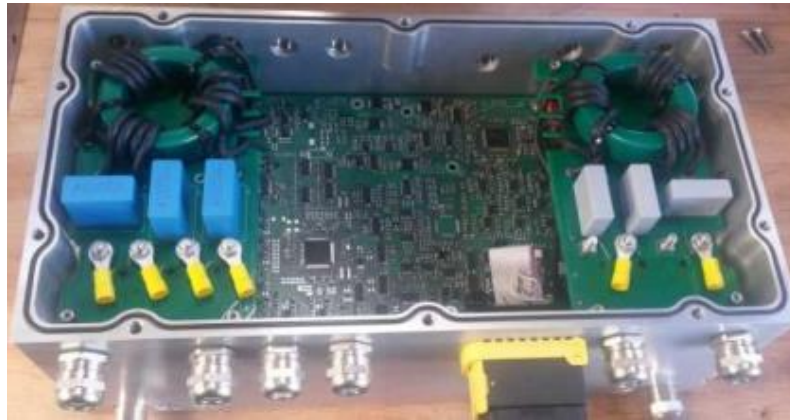
Şekil 1.6: 20 kW’lık şarj modülü (Marzouk 2015).
